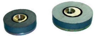
**Art.-Nr. 61 355** Exzentrerscheiben mit Skala (DBGM), Höhenkorrektur ± 4 mm , mit versenkter Bohrung Ø 5 mm und seitlichem Stiftloch zur Verstellung
