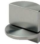
**Art.-Nr. 40 058** wie vor, jedoch  $\varnothing$  30 mm, 1 x lösebare Achse (ein Gewindestift 3 mm im Scharnier ermöglicht das Herausnehmen der Tür nach der Verklebung) **Belastbarkeit: 20 kg / Paar - max. Türgröße 600 x 1.200 mm**
