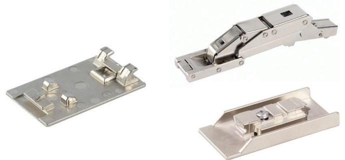
**Art.-Nr. 41 430** Scharnierarm 110° **gedämpft mit Feder** (Dämpfung abschaltbar) für **ein- und aufliegende Glastüren** (bis zu 19 mm Frontaufschlag), Verstellmaße: Höhe ±3 mm, Tiefe +3/-2 mm, Breite ±2 mm für **3 - 8 mm Glasdicke**, **Öffnungswinkel 105°** zu Glastürscharnierset Art.-Nr. 41 425 0 08 und Art.-Nr. 41 4250 08 passend
