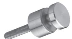
Punkbefestigung  $\varnothing$  16 mm, für 4 - 8 mm Plattendicke, mit 2 KU-Unterlegscheiben, Edelstahl V2A geschliffet
