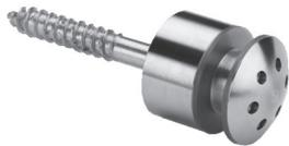
Punktbefestigung, gewölbt,  $\varnothing 22$  mm, für 2 x 4 mm Plattendicke, inkl. Stockschraube M6 x 60 mm, Edelstahl V2A geschichtet
