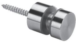
Punktbefestigung  $\varnothing 22$  mm, für 2 x 4 mm Plattendicke, inkl. Senkkopfschraube  $\varnothing 4,5$  x 60 mm, Edelstahl V2A geschichtet
