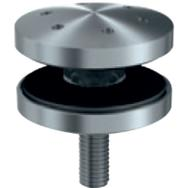
Punkthalter  $\varnothing 40$  mm, gewölbt, für 8 - 12 mm Plattendicke, 2 mm Verstellbarkeit auf 360°, Befestigung mit M8 Zylinderkopfschraube (nicht im Lieferumfang), mit schwarzer EPDM-Unterlegscheibe, Edelstahl V2A geschliffet
