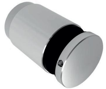
Punkthalter Ø 50 mm für 8 - 17,52 mm Plattendicke, Wandabstand 42 - 50 mm, mit Glasschutz-Set, Wandadapter und Gewindestift M10 x 40 mm
