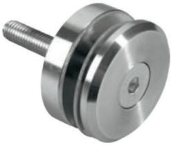
Punkthalter  $\varnothing$  52 mm, für 12 - 21,52 mm Plattendicke, mit 2 KU-Unterlegscheiben, 1 KU-Schlauchstück, mit Schraube DIN 7991 M10 x 70 mm, Edelstahl V2A geschliffet
