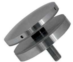
Punkthalter  $\varnothing 72$  mm, für 12 - 21,52 mm Plattendicke, inkl. schwarzem Glasschutz-Set und **Gewindestift M12 x 60 mm**
