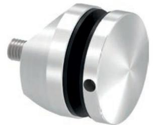
Punkthalter  $\varnothing 52$  mm, für 6 - 25,52 mm Plattendicke, verstellbarer Wandabstand 33 - 55 mm, inkl. schwarzem Glasschutz-Set und **Gewindestift M10 x 130 mm**, Edelstahl V2A 240 Korn geschliffen
