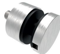
Punkthalter Ø 30 mm für 6 - 12,76 mm Glasdicke, mit Gewindestift M8 x 40 mm und Glasschutz-Set
