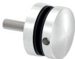
Punkthalter  $\varnothing$  40 mm, für 3 - 12,76 mm Plattendicke, inkl. schwarzem Glasschutz-Set und Gewindestift M8 x 45 mm, Edelstahl V2A 240 Korn geschliffen
