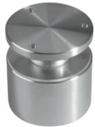
Punkthalter  $\varnothing$  30 mm, für 4 - 14 mm Plattendicke, mit 2 KU-Unterlegscheiben und 1 KU-Schlauchstück, Befestigung mit  $\varnothing$  5 mm Senkkopfschraube (nicht im Lieferumfang), Edelstahl V2A geschliffet
