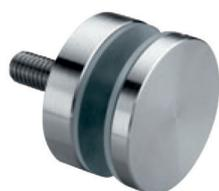
Punkthalter  $\varnothing$  45 mm, für 8 - 21,52 mm Plattendicke, mit 2 KU-Unterlegscheiben, 1 KU-Schlauchstück, Edelstahl V2A geschliffet
