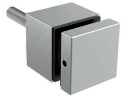
Punkthalter 63 x 63 mm, für 8 - 21,52 mm Plattendicke, inkl. schwarzem Glasschutz-Set und Gewindestift M10 x 70 mm, Edelstahl V2A 240 Korn geschliffen
