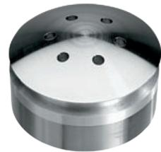
Punkthalter Ø 60 mm, gewölbt, für 8 - 12 mm Plattendicke, 2 mm Verstellbarkeit auf 360°, Befestigung mit M8 Zylinderkopfschraube (nicht im Lieferumfang), mit schwarzer EPDM-Unterlegscheibe, Edelstahl V2A geschliffen
