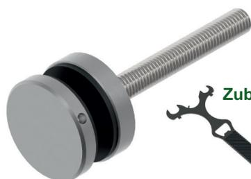
Punkthalter  $\varnothing$  40 mm für 8 - 17,52 mm Glasdicke, mit Gewindestift M10 x 100 mm und Glasschutz-Set, Edelstahl V2A geschliffen
