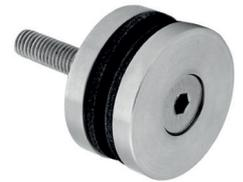
Punkthalter  $\varnothing 40$  mm, für 8 - 13,52 mm Plattendicke, mit 2 KU-Unterlegscheiben, 1 KU-Schlauchstück, mit Gewindestift M8 x 45 mm, Edelstahl V2A geschliffet
