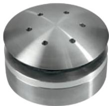
Punkthalter Ø 60 mm, gewölbt, für 8 - 12 mm Plattendicke, 2 mm Verstellbarkeit auf 360°, Befestigung mit M8 Zylinderkopfschraube (nicht im Lieferumfang), mit schwarzer EPDM-Scheibe, Edelstahl V2A geschliffen
