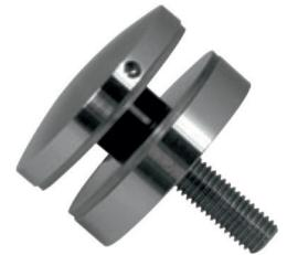
Punkthalter  $\varnothing 52$  mm, für 6 - 21,52 mm Plattendicke, inkl. schwarzem Glasschutz-Set und **Gewindestift M10 x 55 mm**
