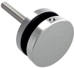
Punkthalter Ø 60 mm für 8 - 17,52 mm Plattendicke, mit Glasschutz-Set und Gewindestift M10 x 100 mm, Edelstahl V2A geschliffen
