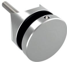
Punkthalter Ø 60 mm für 8 - 17,52 mm Plattendicke, für Rohr Ø 42,4 mm, mit Glasschutz-Set und Gewindestift M10 x 100 mm, Edelstahl V2A geschliffen
