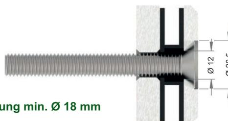
Bohrung min. Ø 18 mm
