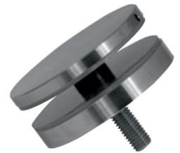
Punkthalter, gewölbt,  $\varnothing 72$  mm, für 12 - 21,52 mm Plattendicke, mit 2 KU-Unterlegscheiben, 1 KU-Schlauchstück und **Gewindestift M10 x 90 mm**, Edelstahl V2A geschliffet
