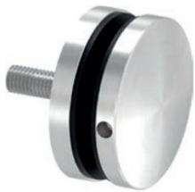
Punkthalter Ø 62 mm, für 6 - 21,52 mm Plattendicke, inkl. schwarzem Glasschutz-Set und Gewindestift M10 x 55 mm, Edelstahl V2A 240 Korn geschliffen
