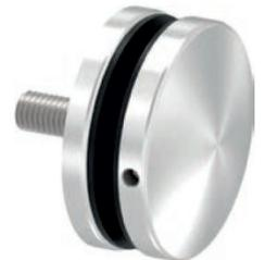
Punkthalter  $\varnothing 70$  mm für 8 - 17,52 mm Glasdicke, mit Glasschutz-Set und **Gewindestift M10 x 45 mm**, Edelstahl V2A geschliffen
