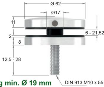
Bohrung min. Ø 19 mm
