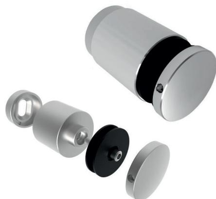
Punkthalter  $\varnothing$  40 mm für 8 - 17,52 mm Glasdicke, Wandabstand 42 - 50 mm, mit Gewindestift M10 x 40 mm, Glasschutz-Set und Wandadapter, Edelstahl V2A geschliffen
