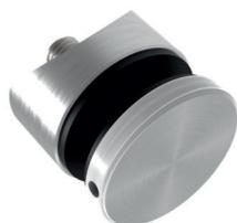
Punkthalter  $\varnothing$  40 mm für 8 - 17,52 mm Glasdicke, für Rohr  $\varnothing$  42,4 mm, mit Gewindestift M10 x 40 mm und Glasschutz-Set, Edelstahl V2A geschliffen
