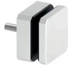
Punkthalter 63 x 78 mm, für 8 - 21,52 mm Plattendicke, inkl. schwarzem Glasschutz-Set und Gewindestift M10 x 70 mm, Edelstahl V2A 240 Korn geschliffen
