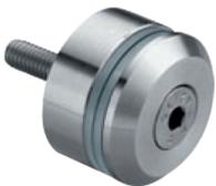
Punkthalter  $\varnothing$  30 mm, für 6 - 20 mm Plattendicke, mit 2 KU-Unterlegscheiben, 1 KU-Schlauchstück und mit Gewindeschraube M8 x 45 mm und Senkkopfschraube 8 x 50 mm für Holzbefestigung, Edelstahl V2A geschliffet
