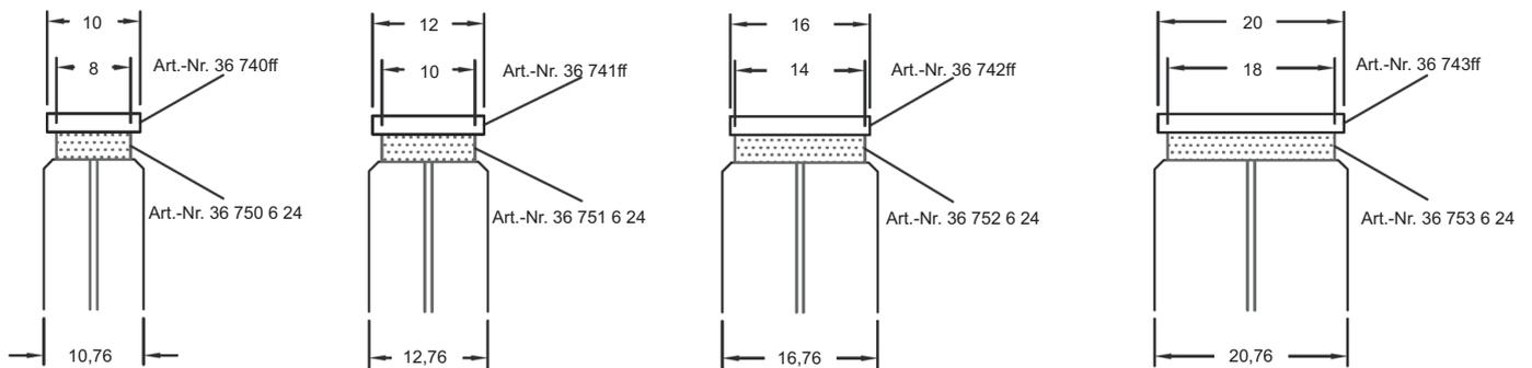
Doppelseitiges Klebeband zur Befestigung von Handlauf und Kantenschutz, **12 Meter / Rolle**, Kunststoff transparent
