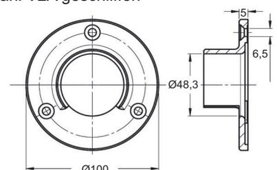
Rohrverbinder 180° für Nutrohr  $\varnothing 42,4 \times 1,5$  mm
