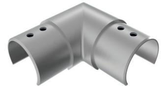
Rohrverbinder 90° für Nutrohr  $\varnothing 48,3 \times 1,5$  mm, Edelstahl V2A geschliffen
