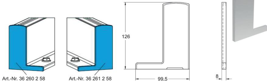
Endkappe zu Ganzglasgeländer-Grundprofil Art.-Nr. 36 251ff in Kombination mit Abdeckprofil Art.-Nr. 36 295ff, Befestigung mittels doppelseitigem Klebeband (nicht im Lieferumfang enthalten), Aluminium geschliffen silberfarbig eloxiert
