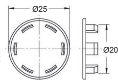
Endkappe zu Ganzglasgeländer-Grundprofil Art.-Nr. 36 301ff, Befestigung mittels doppel-seitigem Klebeband (nicht im Lieferumfang enthalten)
