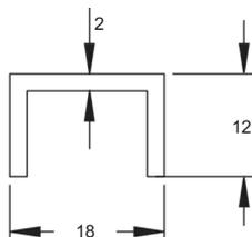
Kantenschutz 12 x 18 x 12 x 2 mm, für 12 - 13,52 mm Glasdicke, Länge: 6.000 mm
