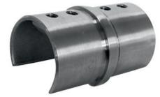
Rohrverbinder 180° für Nutrohr  $\varnothing 48,3 \times 1,5$  mm, Edelstahl V2A geschliffen
