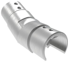
Rohrverbinder verstellbar von 25 - 55° für Nutrohr  $\varnothing$  42,4 x 1,5 mm,
