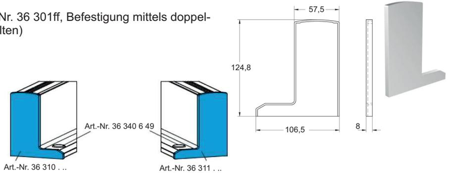
Endkappe zu Ganzglasgeländer-Grundprofil Art.-Nr. 36 301ff in Kombination mit Abdeckprofil Art.-Nr. 36 295ff, Befestigung mittels doppelseitigem Klebeband (nicht im Lieferumfang enthalten)
