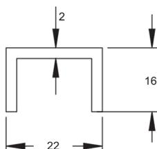
Kantenschutz 16 x 22 x 16 x 2 mm, für 16 - 17,52 mm Glasdicke, Länge: 3.000 mm, Aluminium geschliffen silberfarbig eloxiert
