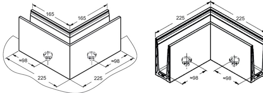
Blech (zur Entwässerung) zu Ganzglasgeländer-Grundprofil Art.-Nr. 36 101ff, Edelstahl V2A roh
