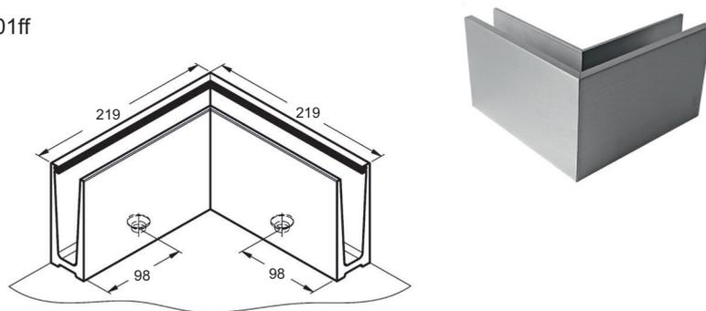
Entwässerungsprofil zu Ganzglasgeländer-Grundprofil Art.-Nr. 36 001ff, Länge: 412 mm, Aluminium silberfarbig eloxiert
