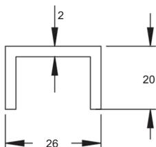
Kantenschutz 20 x 26 x 20 x 2 mm, für 20 - 21,52 mm Glasdicke, Länge: 6.000 mm
