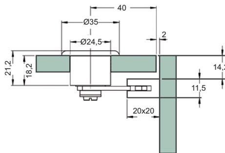
**Art.-Nr. 50 200** Glastür-Hebelschloß zum **UV-Verkleben**, mit 2 Schlüsseln, **gleichschlieBend**, rechts und links verwendbar (Riegel und Schließzylinder können durch Lösen der Schraube umgedreht werden) für **6 - 15 mm Glasdicke**
