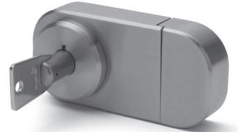
**Art.-Nr. 50 215** Glastürzylinderschloß zum **UV-Verkleben**, für **einliegende** Glastüren, rechts, mit 2 Schlüsseln, **gleichschließend**, für **6 - 12 mm Glasdicke**
