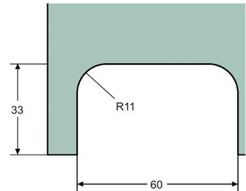
**Art.-Nr. 53 200** Glastürschloss für **einflügelige Türen** von 4 - 8 mm Glasdicke, **gleichschließend**, mit 2 Schlüsseln
