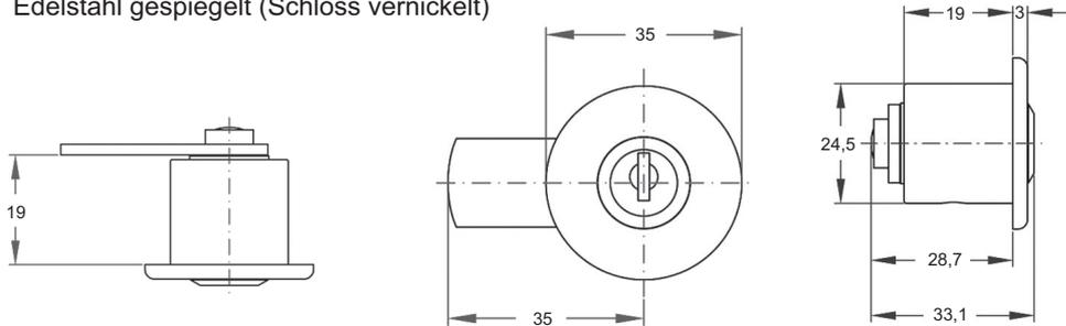
**Art.-Nr. 50 201** Glastür-Hebelschloss zum **UV-Verkleben**, mit 2 Schlüsseln, **gleichschlieBend**, rechts und links verwendbar (Riegel und Schließzylinder können durch Lösen der Schraube umgedreht werden) für **6 - 15 mm Glasdicke**
