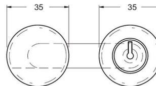
Glasbohrung Ø 25 mm
