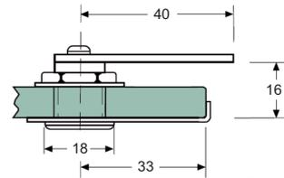
**Glasbohrung Ø 16 mm**
