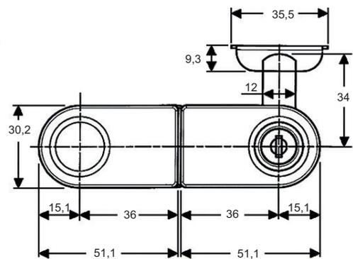
**Art.-Nr. 50 210** Glastürzylinderschloß zum **UV-Verkleben**, für **doppelflügelige** Glastüren, rechts, mit 2 Schlüsseln, **gleichschließend**, für **6 - 12 mm Glasdicke**
