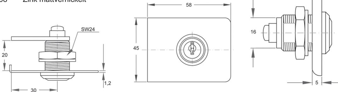
**Art.-Nr. 53 110** Glastürzylinder-Hebelschloss (Hebel gerade), rechts und links verwendbar, mit 2 Schlüsseln und Schließwinkel, **gleichschließend**, für 4 - 8 mm Materialdicke
