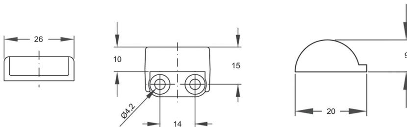
**Art.-Nr. 53 060** Glastürschloss für 6 - 8 mm Glasdicke, **gleichschließend**, mit 3 Schlüsseln (Schlüssel ist nur herausziehbar, wenn das Schloss verriegelt ist) und 1 Schließblech
