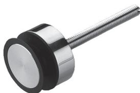
**Punktbefestigung Ø 29 mm, für 8 - 12 mm Plattendicke, 2 mm Verstellbarkeit auf 360°, Befestigung mit einem M6 Gewindestift mit Schraubkopfadaption und Abdeckkappe für Schraubkopf aus Edelstahl, Senkkopfbuchse aus schwarzem Kunststoff, Edelstahl (1.4301) geschliffen**
