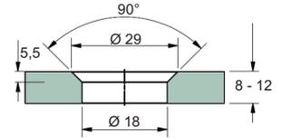
Punktbefestigung  $\varnothing 29$  mm, für 8 - 12 mm Plattendicke, 2 mm Verstellbarkeit auf 360°, Abdeckkappe für Schraubenkopf aus Edelstahl und **Senkkopfbuchse aus schwarzem Kunststoff**, mit Innengewinde M8, Edelstahl V2A geschichtet
