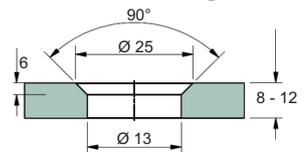
**Versenkter Punkthalter  $\varnothing 20$  mm** für 8 - 12 mm Glasdicke, mit Gewinde M8 x 30 mm, inkl. Glasschutz-Set, Edelstahl V2A roh
