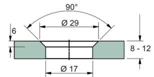
Punktbefestigung  $\varnothing 25$  mm, für 8 - 12 mm Plattendicke, 2 mm Verstellbarkeit auf 360°, Abdeckkappe für Schraubenkopf aus Edelstahl und **Senkkopfbuchse aus schwarzem Kunststoff**, Edelstahl V2A geschichtet
