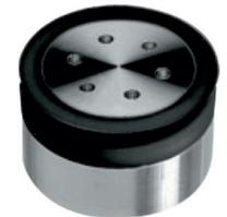
**Versenkter Punkthalter  $\varnothing 40$  mm** für 8 - 12 mm Glasdicke, mit Gewinde M10 x 30 mm, inkl. Glasschutz-Set, Edelstahl (1.4305) roh
