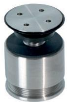
**Versenker Punkthalter Ø 30 mm, für 8 - 10 mm Glasdicke, Wandabstand von 20 - 27 mm verstellbar, Befestigungspunkt durch Langloch justierbar, mit Glasschutzset, Edelstahl (1.4305) Feinschliff**
