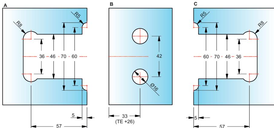
**Art.-Nr. 46 170** Winkelverbinder **Flamea+**, starr, **Glas-Wand 90°**, für 6 - 10 mm **Glasdicke**, Wandbefestigung mit Langlochverstellung und verdeckte Verschraubung mit Abdeckplatte
