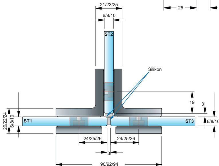
**Art.-Nr. 46 583** Stabilisierungsstange **Wand-Glas**, für 6 - 10 mm Glasdicke, Stange von 1.570 - 1.730 mm verstellbar
