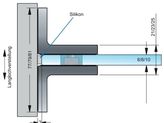
**Art.-Nr. 46 171** Winkelverbinder **Flamea+**, starr, **Glas-Glas 90°**, für **6 - 10 mm Glasdicke**, mit **Abdeckkappe** (verdeckte Verschraubung)
