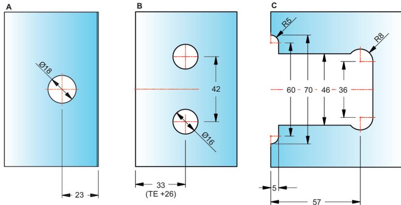
**Art.-Nr. 46 169** Zweiseitiges Pendeltürband **Flamea+**, **Glas-Glas-Glas 90°**, **beidseitig 90° öffnend**, für **6 - 10 mm Glasdicke**, mit verstellbarer Nulllagenstellung und Abdeckkappen (verdeckte Verschraubung)
