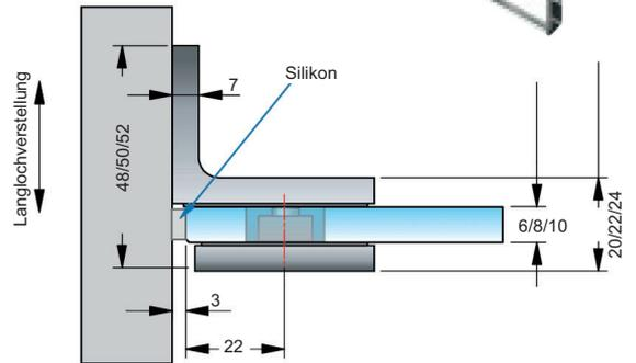
**Art.-Nr. 46 173** Winkelverbinder zweiseitig **Flamea+**, starr, **Glas-Wand 90°**, für 6 - 10 mm **Glasdicke**, beidseitige Befestigungsglasche und verdeckte Verschraubung mit Abdeckplatte
