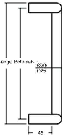
**Art.-Nr. 58 360** Stangengriff  $\varnothing$  25 mm, aus Edelstahl-Rohr, für Glas-, Holz-, Aluminium- und Kunststofftüren, **Länge: 325 mm, einseitig**, Bohrmaß: 300 mm, (das Befestigungsset M8 bitte separat mitbestellen)
