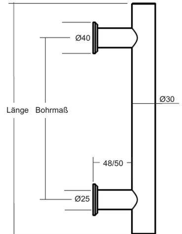
**Wir empfehlen für Glastürblätter ab einer Grifflänge von 1.500 mm und für Holztüren ab einer Grifflänge von 1.800 mm eine dritte Griffstütze, um ein Durchbiegen des Türblattes zu vermeiden**
