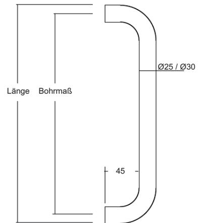
**Art.-Nr. 58 320** Stangengriff  $\varnothing$  30 mm, aus Edelstahl-Rohr, für Glas-, Holz-, Aluminium- und Kunststofftüren, **Länge: 430 mm, einseitig**, Bohrmaß: 400 mm, **(das Befestigungsset M8 bitte separat mitbestellen)**
