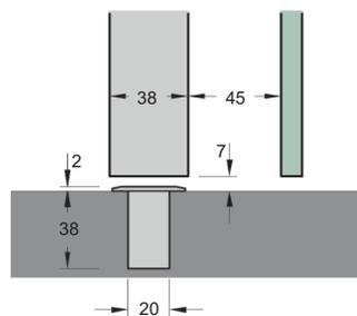
**Art.-Nr. 59 520** **Abschließbarer Stoßgriff Ø 38 mm**, aus Edelstahl-Rohr, beidseitig schließbar für Halbprofilzylinder 30 / 30 inkl. Bodenhülse mit Abdeckblech, **innen Schließzylinder / außen Knaufzylinder**, Befestigung für 8 mm, 10 mm, 12 mm Glasstärke, **Länge: 2.000 mm**
