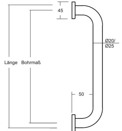
**Art.-Nr. 58 340** Stangengriff  $\varnothing$  25 mm, aus Edelstahl-Rohr, mit **Rosetten**, für Glas-, Holz-, Aluminium- und Kunststofftüren, **Länge: 325 mm, einseitig**, Bohrmaß: 300 mm, (**das Befestigungsset M8 bitte separat mitbestellen**)
