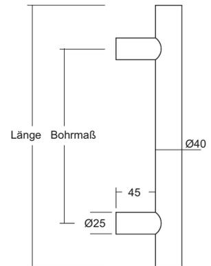
**Wir empfehlen für Glastürblätter ab einer Griffhöhe von 1.500 mm und für Holztüren ab einer Griffhöhe von 1.800 mm eine dritte Griffstütze, um ein Durchbiegen des Türblattes zu vermeiden**
