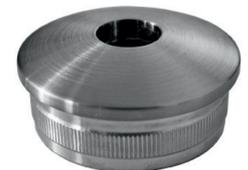
Endkappe, **flach, mit Durchgangsbohrung Ø 12,1 mm**, Vollmaterial, zum **Einschlagen**, Edelstahl V2A 240 Korn geschliffen
