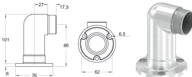
Wandhalter 90° zum Einstecken, rund, für Rohr  $\varnothing 42,4 \times 2,0$  mm
