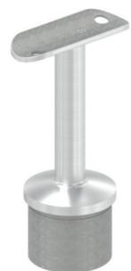
Handlaufstütze mit Anschlussplatte (mit 2 Bohrungen Ø 6,5 mm), Stopfen zum Einkleben / Einschweißen
