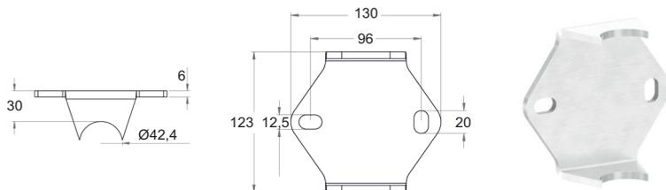
Wandbefestigung zum Verschrauben von hinten, inkl. 2 x Schraube M10 x 60 mm, Wandabstand: 40 mm, Edelstahl V2A 240 Korn geschliffen
