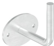
Handlaufhalter zum Anschweißen, Ronde mit 2 Bohrungen Ø 6,5 mm, Edelstahl V2A 240 Korn geschliffen
