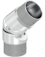
Gelenkstück **zum Einstecken**, für Rohr  $\varnothing 42,4 \times 2,0$  mm, Öffnungswinkel 90 - 180°, Edelstahl V2A 240 Korn geschliffen
