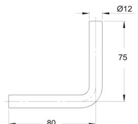
Bügel, **beidseitig flach**, Edelstahl V2A 240 Korn geschliffen
