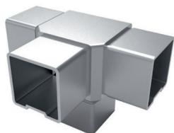
T-Stück 90° **zum Einstecken**, mit 4 gleichen Abgängen, für Rohr 40 x 40 x 2 mm, Edelstahl V4A geschliffen
