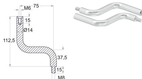
Gelenkbügel Ø 14 mm (Winkel 0 - 75°), **1 x Außengewinde M8** und **1 x Innengewinde M6**, **Länge: 112,5 mm**, Edelstahl V2A 240 Korn geschliffen
