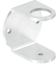
Wandbefestigung für Geländerpfosten, Wandabstand: 40 mm, für Rohr Ø 42,4 mm, Edelstahl V2A 240 Korn geschliffen
