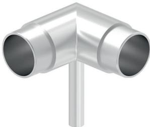
Steckecke 90° mit Stift  $\varnothing$  12 mm, für **Rohr  $\varnothing$  42,4 x 2,0 mm**, Edelstahl V2A 240 Korn geschliffen
