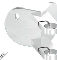
Wandbefestigung **verstellbar**, für **Innen- und Außenecken**, mit **2 Spannringen**, Wandabstand: 45 mm, für **Rohr Ø 42,4 mm**, Edelstahl V2A 240 Korn geschliffen
