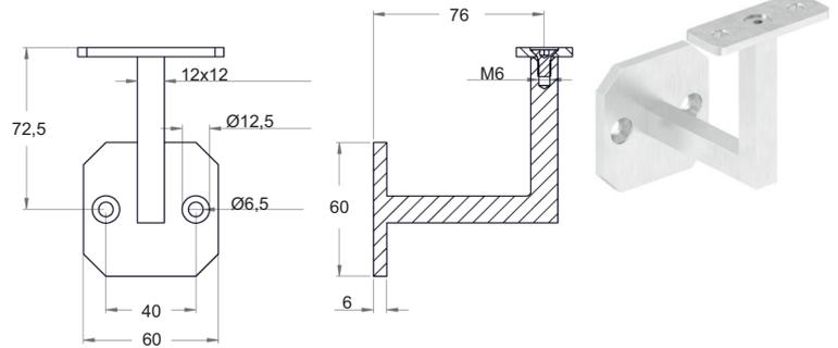
Handlaufhalter mit Gelenk und verschraubter, flacher Anschlussplatte (mit 2 Bohrungen  $\varnothing$  6,5 mm), Ronde mit 2 versenkten Bohrungen  $\varnothing$  6,5 mm (gesenkt für M6)
