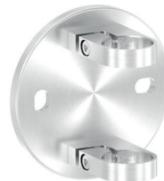
Wandbefestigung mit **2 Spannringen**, inkl. 4 x Schraube, Wandabstand: 45 mm, für **Rohr Ø 42,4 mm**, Edelstahl V2A 240 Korn geschliffen
