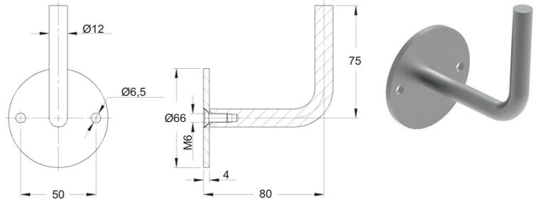
Handlaufhalter **zum Anschweißen**, Ronde mit **2 Bohrungen Ø 6,5 mm**
