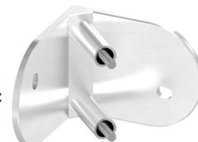
Wandbefestigung für **90° Außenecke**, **zum Verschrauben**, inkl. 2 x Schraube **M8 x 90 mm** (ISO 10642) und 2 x Distanzhülse - Wandabstand: 50 mm, für **Rohr Ø 42,4 mm**, Edelstahl V2A 240 Korn geschliffen
