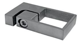
Spannring für Rohr 40 x 40 mm, inkl. 2 x Schraube M8 x 20 mm, Edelstahl V2A 240 Korn geschliffen
