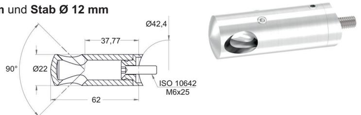
Querstabhalter Ø 25 mm mit Durchgangsbohrung, Edelstahl V2A 240 Korn geschliffen
