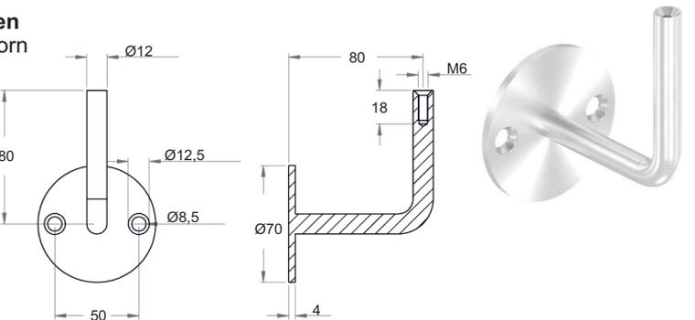
Handlaufhalter mit Innengewinde M6, Ronde mit 3 Bohrungen  $\varnothing$  6,5 mm, inkl. Clipsette, Edelstahl V2A geschliffen
