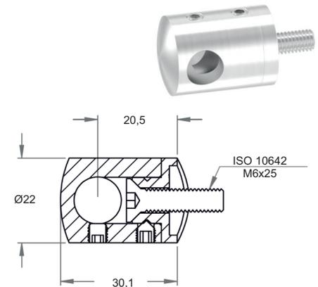
Querstabhalter Ø 22 mm für 90° Außenecke, für Rohr Ø 42,4 mm und Stab Ø 12 mm
