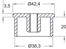
Rohrabschlussstopfen mit Innengewinde, **zum Einstecken**, für Rohrbogen 90°
