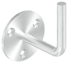
Handlaufhalter zum Anschweißen, Ronde mit 3 versenkten Bohrungen Ø 6,5 mm (gesenkt für M6), Edelstahl V2A 240 Korn geschliffen
