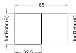
Verbindungsring zum Verdecken der Schnittkanten, **zum Einstecken**
