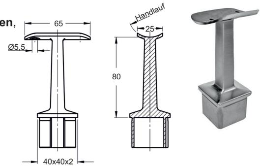
Handlaufstütze mit Anschlussplatte (mit 2 Bohrungen Ø 6,5 mm), Stopfen zum Einschlagen, Edelstahl V2A 240 Korn geschliffen
