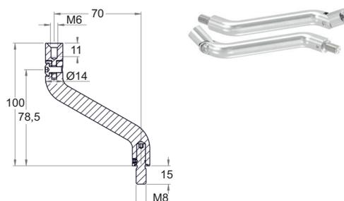
Bügel Ø 14 mm, **1 x Außengewinde M8** und **1 x Innengewinde M6**, **Länge: 112,5 mm**, Edelstahl V2A 240 Korn geschliffen
