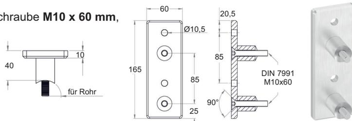
Wandbefestigung zum Festklemmen mittels Madenschraube, Wandabstand: 40 mm, Edelstahl V2A 240 Korn geschliffen
