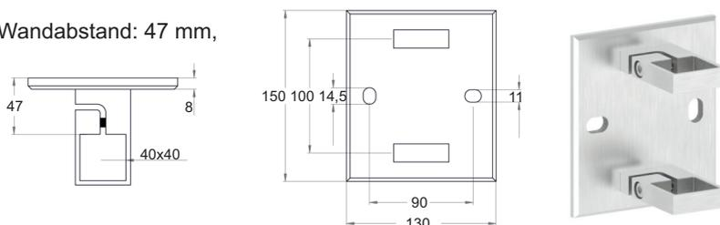
Wandbefestigung 90° mit 2 Spannringen, inkl. 4 x Schraube, Wandabstand: 47 mm, für Rohr 40 x 40 mm, Edelstahl V2A 240 Korn geschliffen
