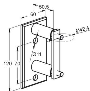
Wandbefestigung für **90° Innenecke**, **zum Verschrauben**, inkl. 2 x Schraube **M8 x 80 mm** (ISO 10642) und 2 x Distanzhülse - Wandabstand: 50 mm, für **Rohr Ø 42,4 mm**, Edelstahl V2A 240 Korn geschliffen
