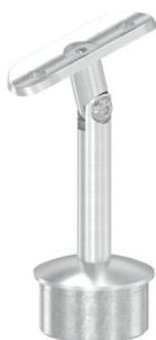
Handlaufstütze mit **Gelenk** und **verschraubter Anschlussplatte** (mit 2 Bohrungen Ø 6,5 mm), Stopfen **zum Einkleben / Einschweißen**, Edelstahl V2A 240 Korn geschliffen
