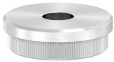
Endkappe, **flach, mit Entwässerungsbohrung Ø 5 mm**, Vollmaterial, **zum Einschlagen**,
