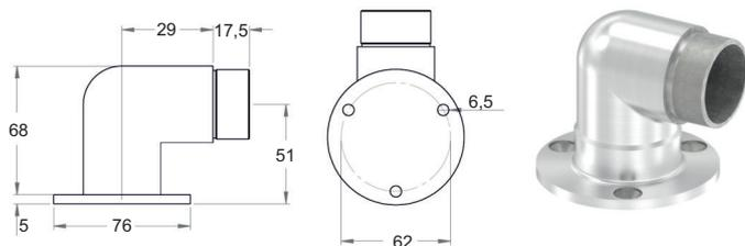
Wandhalter 90° zum Einstecken, lang, für Rohr  $\varnothing 42,4 \times 2,0$  mm, Edelstahl V2A 240 Korn geschliffen
