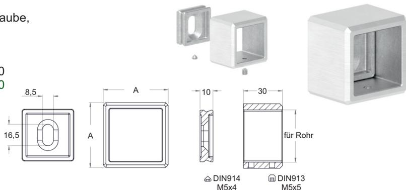
Wandbefestigung für **Rohr 40 x 40 mm, zum Festklemmen** mittels Madenschraube, Edelstahl V2A geschliffen
