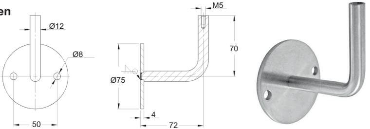
Handlaufhalter mit Innengewinde M6, Ronde mit 2 versenkten Bohrungen  $\varnothing$  8,5 mm (gesenkt für M6), Edelstahl V2A 240 Korn geschliffen
