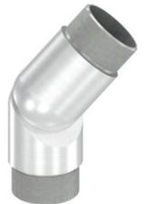
Gelenkstück **zum Einstecken**, einseitig zum Anschrauben, für Rohr  $\varnothing 42,4$  mm, Öffnungswinkel 0 - 70°, Edelstahl V2A 240 Korn geschliffen
