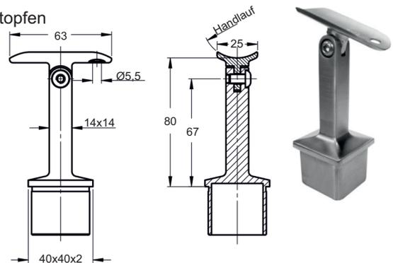
Handlaufstütze mit Gelenk und Anschlussplatte (mit 2 Bohrungen Ø 6,5 mm), zum Einschlagen, Edelstahl V2A 240 Korn geschliffen
