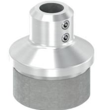
Endkappe, **gewölbt, mit Durchgangsbohrung Ø 12,3 mm**, Vollmaterial, zum **Einschlagen**, für **Rohr Ø 42,4 x 2,0 mm**, Edelstahl V2A geschliffen
