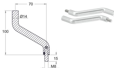
Bügel Ø 14 mm, **1 x Außengewinde M8** und **1 x Innengewinde M6**, 360° drehbar (mittels Klemmsystem durch seitliche Madenschraube beliebig am Pfosten ausrichtbar), **Länge: 100 mm**, Edelstahl V2A 240 Korn geschliffen
