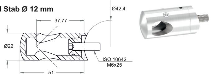
Querstabhalter Ø 22 mm für 90° Innenecke, für Rohr Ø 42,4 mm und Stab Ø 12 mm
