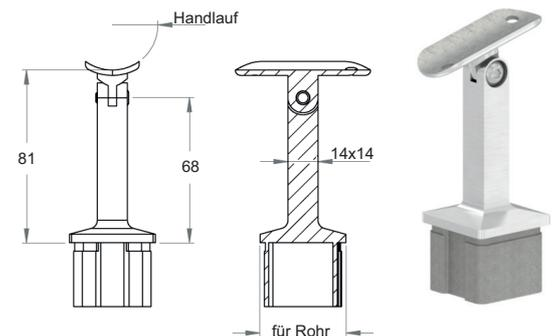
Handlaufstütze mit Anschlussplatte 90° (mit 2 Bohrungen Ø 6,5 mm), zum Einschlagen, für Rohr 40 x 40 x 2,0 mm
