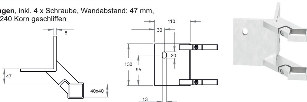
Wandbefestigung mit Glasabsturzicherung, Wandabstand: 30 mm, für Rohr Ø 42,4 mm, Edelstahl V2A 240 Korn geschliffen
