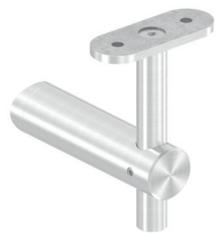
Handlaufhalter mit **verschraubter Anschlussplatte** (mit 2 Bohrungen Ø 5,5 mm) und **verstellbarer Höhe** (Lieferung ohne Befestigungsschraube - kann mit einer M6 x 30 mm oder M8 x 30 mm Senkkopfschraube ISO 10642 befestigt werden), Edelstahl V2A 240 Korn geschliffen
