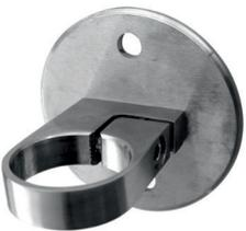
Wandbefestigung **mit 1 Spannring**, inkl. 2 x Schraube, Wandabstand: 40,8 mm, für **Rohr Ø 42,4 mm**, Edelstahl V2A geschliffen
