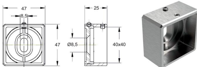
Wandbefestigung **zum Verschrauben**, inkl. 2 x Schraube **M8 x 65 mm** (ISO 10642) und 2 x Distanzhülse - Wandabstand: 50 mm
