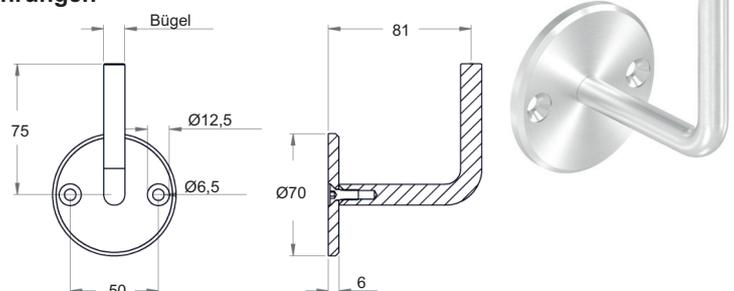
Handlaufhalter **zum Anschweißen**, Ronde mit **3 Bohrungen Ø 6,5 mm**,
