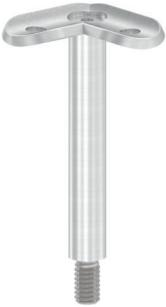
Stift mit **verschraubter Anschlussplatte 90°** (mit 2 Bohrungen  $\varnothing$  6,5 mm) und **1 x Außengewinde M8**, Edelstahl V2A 240 Korn geschliffen
