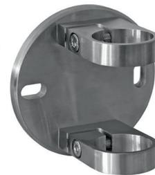
Wandbefestigung mit **2 Spannringen**, inkl. 4 x Schraube, Wandabstand: 45 mm, Edelstahl V2A 240 Korn geschliffen
