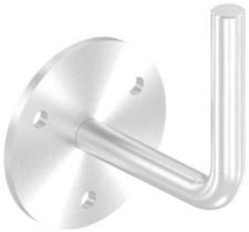
Handlaufhalter zum Anschweißen, Ronde mit 3 Bohrungen Ø 6,5 mm, Edelstahl V2A 240 Korn geschliffen
