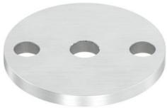
Ankerplatte rund, ohne Fase, mit Längsschliff, Edelstahl V2A 240 Korn einseitig geschliffen
