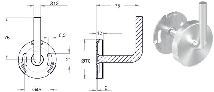
Handlaufhalter **zum Anschweißen**, Ronde mit **2 Bohrungen**
