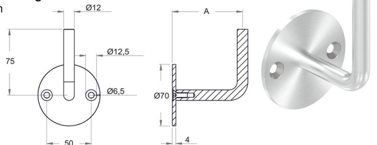
Handlaufhalter **zum Anschweißen**, Ronde mit **2 versenkten Bohrungen**
