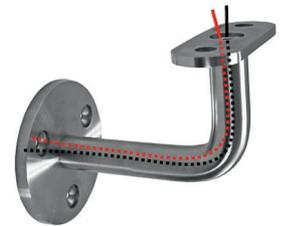
Handlaufhalter mit verschraubter Anschlussplatte (mit 2 Bohrungen Ø 6,5 mm), hohl für LED Handlauf, Ronde mit 3 Bohrungen Ø 6,5 mm (gesenkt für M6)
