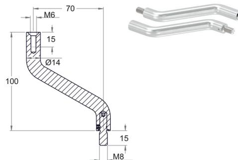
Gelenkbügel Ø 14 mm, **1 x Außengewinde M8** und **1 x Innengewinde M6**, 360° drehbar (mittels Klemmsystem durch seitliche Madenschraube beliebig am Pfosten ausrichtbar), **Länge: 100 mm**, Edelstahl V2A 240 Korn geschliffen
