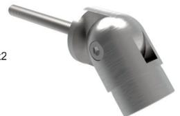
Gelenkstück 90° **zum Einstecken**, verstellbar 0 - 70°, für Rohr  $\varnothing 42,4 \times 2,0$  mm, Edelstahl V2A 240 Korn geschliffen
