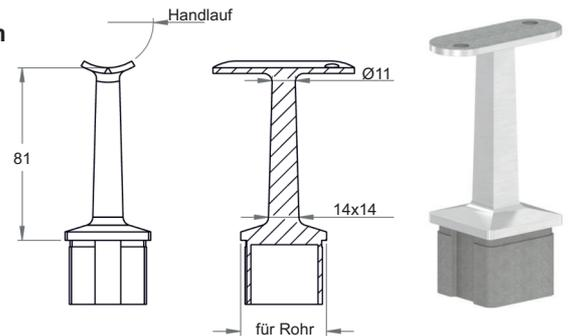
Handlaufstütze mit Gelenk und Anschlussplatte (mit 2 Bohrungen Ø 5,5 mm), Stopfen zum Einschlagen, für Rohr 40 x 40 x 2,0 mm
