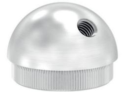
Endkappe, mit **Durchgangsbohrung Ø 12 mm**, für **Rohr Ø 42,4 x 2,0 mm**, zum **Einkleben / Einschweißen**, Edelstahl V2A geschliffen
