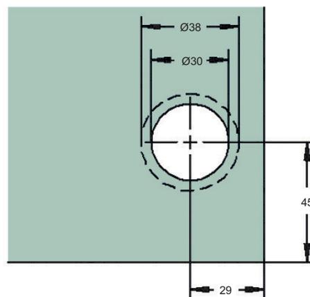
**Art.-Nr. 47 515** Winkelverbinder **Plan artist Glas-Wand 90°**, Anschraubplatte nach innen für **8 mm Glasdicke**, innen flächenbündig und inkl. verdeckter Verschraubung
