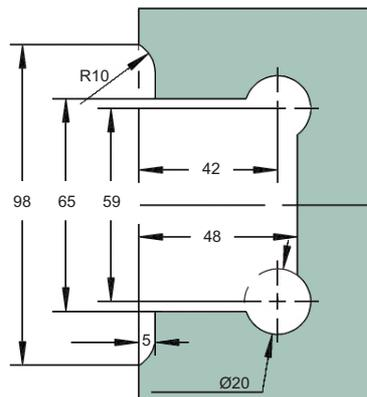
Art.-Nr. 47 136 Duschtürpendelband **Barcelona** mit automatischer Rückholzone von  $\sim \pm 15^\circ$ , Glas-Glas  $180^\circ$ , Öffnungswinkel beidseitig  $90^\circ$ , für 8 - 12 mm Glasdicke
