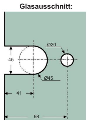
**Art.-Nr. 47 405** Duschtürband **Granada mit Rückholfunktion** (automatisch ~ ±15 Grad), **Glas-Glas 90°**, Öffnungswinkel beidseitig 90°, Nulllage stufenlos einstellbar, für **8 - 10 mm Glasdicke**
