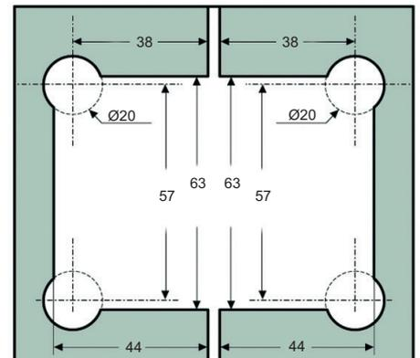
**Art.-Nr. 47 167** Duschtürpendelband **Bilbao Select** mit automatischer Rückholzone von  $\sim \pm 15^\circ$ , **Glas-Glas 135°**, Öffnungswinkel beidseitig  $90^\circ$ , Nulllage stufenlos einstellbar, für 8 - 12 mm **Glasdicke**
