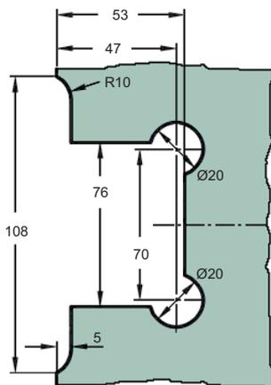
**Glasbearbeitung mit Dichtung Art.-Nr. 46 830ff:**
