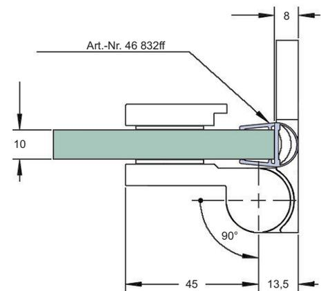
Art.-Nr. 47 620 Duschtürband Madrid HS mit Hebe-Senk-Funktion, Glas-Glas 180°, 180° nach außen öffnend, DIN links, für 6 - 10 mm Glasdicke, inkl. verdeckter Verschraubungen
