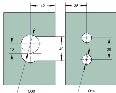
**Art.-Nr. 47 422** Duschtürpendelband **Juna selbstschließend, Glas-Glas 180°**, Öffnungswinkel beidseitig 90°, Nulllage stufenlos einstellbar, für **6 - 10 mm Glasdicke**, Schrauben am Band verdeckt
