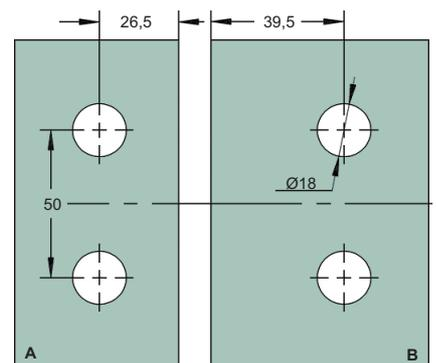
**Art.-Nr. 47 140** Duschtürpendelband **Bilbao** mit automatischer Rückholzone von  $\sim \pm 15^\circ$ , Wand-Glas  $90^\circ$ , Öffnungswinkel beidseitig  $90^\circ$ , für 8 - 12 mm Glasdicke
