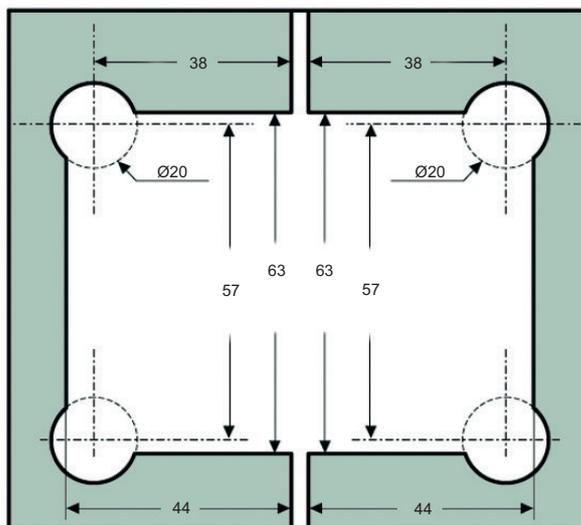
Art.-Nr. 47 446 Duschtürpendelband **Barcelona Select**, mit automatischer Rückholzone von  $\sim \pm 15^\circ$ , Glas-Glas  $135^\circ$ , Öffnungswinkel beidseitig  $90^\circ$
