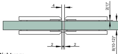
**Glasbearbeitungen mit Dichtung:**
