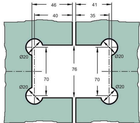
**Glasbearbeitung mit Dichtung Art.-Nr. 46 834 6 76:**
