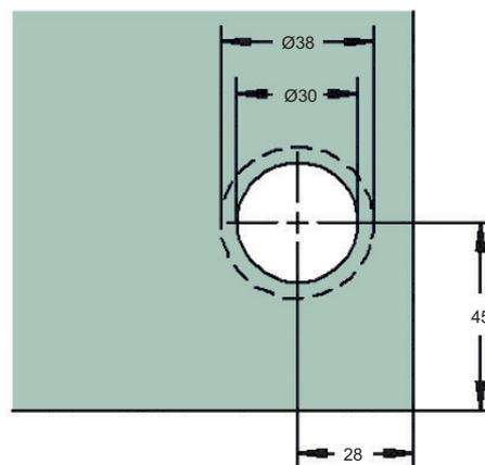
**Art.-Nr. 47 509** Duschtürpendelband **Plan artist** mit **Hebe-Senk-Funktion** (Hubhöhe 5 mm), **Glas-Glas 135°**, **DIN links**, für **8 mm Glasdicke**, Einrastfunktion bei einer Öffnung von ca. 95°, innen flächenbündig, mit einstellbarer Nulllage und inkl. verdeckter Verschraubungen
