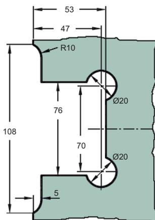
**Glasbearbeitung mit Dichtung Art.-Nr. 46 830ff:**
