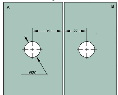
**Art.-Nr. 47 290** Duschtüranschlagband **Avila, Glas-Wand 90°**, mit Hohlkehle, nach außen öffnend, Öffnungswinkel 90°, für 6 - 10 mm Glasdicke, mit verdeckter Verschraubung
