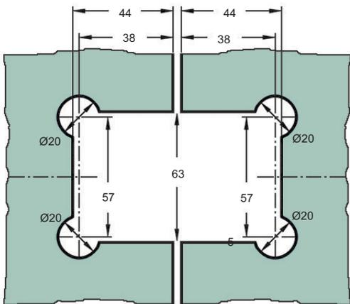
**Glasbearbeitung mit Dichtung Art.-Nr. 46 830ff:**
