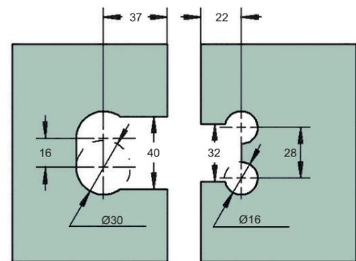
**Art.-Nr. 47 425** Winkelverbinder Juna, Wand-Glas 90°, für 6 - 10 mm Glasdicke, Wandbefestigung und Schrauben am Band verdeckt
