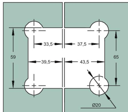
**Art.-Nr. 47 095** Winkelverbinder **Santos Wand-Glas 90°**, für 8 - 10 mm Glasdicke, mit verdeckter Verschraubung
