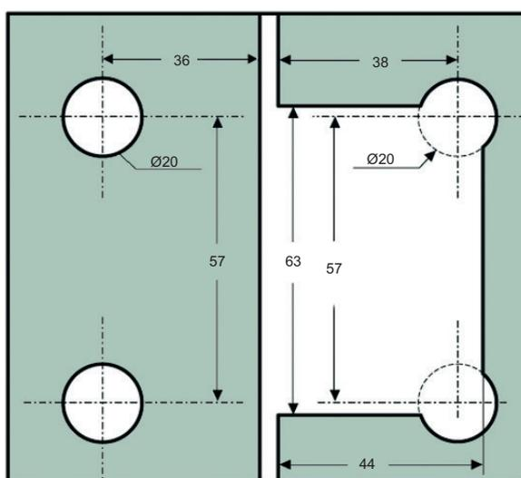
Art.-Nr. 47 445 Duschtürpendelband **Barcelona Select**, mit automatischer Rückholzone von  $\sim \pm 15^\circ$ , Glas-Glas 180°, Öffnungswinkel beidseitig 90°, Nulllage stufenlos einstellbar, für 8 - 12 mm Glasdicke
