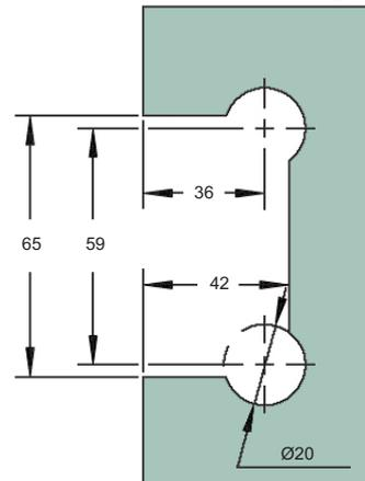
**Art.-Nr. 47 091** Duschtürpendelband **Santos mit automatischer Rückholzone von  $\sim \pm 15^\circ$ , Glas-Glas 180°**, Öffnungswinkel beidseitig 90°, Nulllage stufenlos einstellbar, für 8 - 10 mm Glasdicke, inkl. verdeckten Verschraubungen
