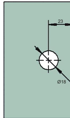
**Art.-Nr. 47 298** Winkelverbinder **Avila Glas-Glas 90°**, für 6 - 10 mm Glasdicke, mit verdeckter Verschraubung
