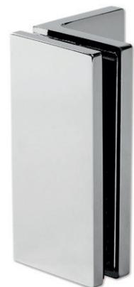
**Art.-Nr. 47 400** Duschtürband **Granada mit Rückholfunktion** (automatisch ~ ±15 Grad), **Glas-Wand 90°**, Öffnungswinkel beidseitig 90°, Nulllage stufenlos einstellbar, für **8 - 10 mm Glasdicke**
