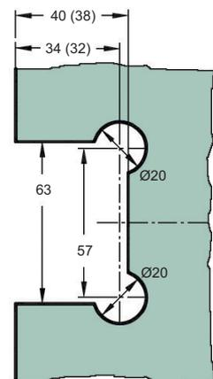
**Art.-Nr. 47 176** Duschtürpendelband **Bilbao Premium** mit automatischer Rückholzone von  $\sim \pm 15^\circ$ , **Wand-Glas 90°**, Öffnungswinkel beidseitig 90°, Nulllage stufenlos einstellbar, für **8 - 12 mm Glasdicke**, inkl. verdeckten Verschraubungen
