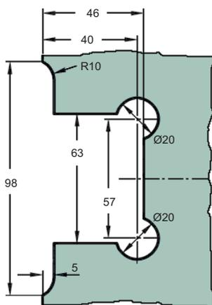
**Glasbearbeitung mit Dichtung Art.-Nr. 46 830ff:**
