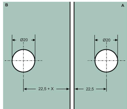
**Art.-Nr. 47 175** Duschtürpendelband **Bilbao Premium** mit **automatischer Rückholzone von  $\pm 15^\circ$** , **Wand-Glas  $90^\circ$** , **Öffnungswinkel beidseitig  $90^\circ$** , **Nulllage stufenlos einstellbar**, für **8 - 12 mm Glasdicke**, inkl. verdeckten Verschraubungen
