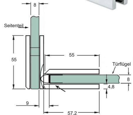
**Glasbearbeitung mit Dichtung Art.-Nr. 46 830ff:**
