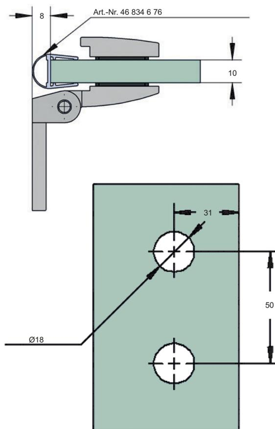
**Art.-Nr. 47 295** Duschtüranschlagband **Avila, Glas-Glas 180°**, Öffnungswinkel 180°, für **6 - 10 mm Glasdicke**, mit verdeckter Verschraubung
