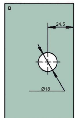
**Art.-Nr. 47 500** Duschtürpendelband **Plan artist** mit **Hebe-Senk-Funktion** (Hubhöhe 5 mm), **Wand-Glas 90°**, **DIN links**, für **8 mm Glasdicke**, Einrastfunktion bei einer Öffnung von ca. 95°, innen flächenbündig, mit einstellbarer Nulllage und inkl. verdeckter Verschraubungen
