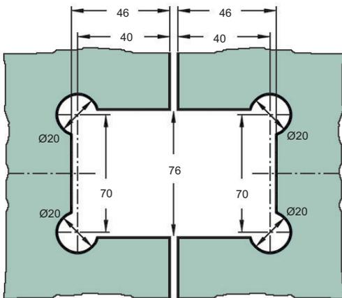
**Glasbearbeitung mit Dichtung Art.-Nr. 46 830ff:**
