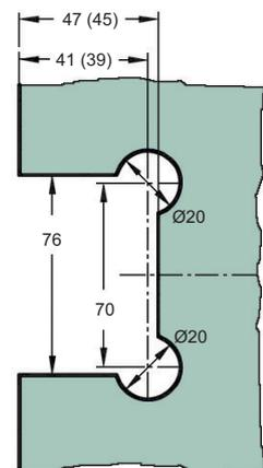
**Art.-Nr. 47 193** Duschtürpendelband **Bilbao Premium HD** mit automatischer Rückholzone von  $\sim \pm 15^\circ$ , Glas-Glas  $180^\circ$ , Öffnungswinkel beidseitig  $90^\circ$ , Nulllage stufenlos einstellbar, für 8 - 12 mm Glasdicke
