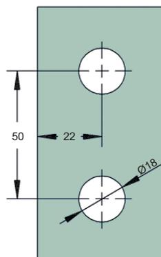
**Art.-Nr. 47 297** Winkelverbinder **Avila Wand-Glas 90°**, für 6 - 10 mm Glasdicke, mit verdeckter Verschraubung
