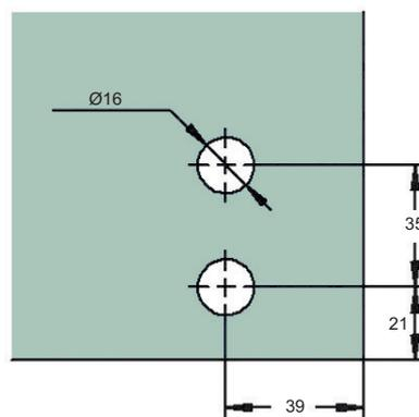
**Art.-Nr. 47 506** Duschtürpendelband **Plan artist** mit **Hebe-Senk-Funktion** (Hubhöhe 5 mm), **Glas-Glas 180°**, **DIN links**, für **8 mm Glasdicke**, Einrastfunktion bei einer Öffnung von ca. 95°, innen flächenbündig, mit einstellbarer Nulllage und inkl. verdeckter Verschraubungen
