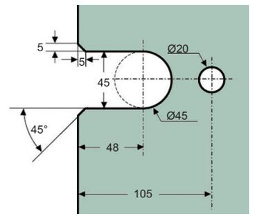
**Art.-Nr. 47 406** Duschtürband **Granada mit Rückholfunktion** (automatisch ~ ±15 Grad), **Glas-Glas 180°**, Öffnungswinkel beidseitig 90°, Nulllage stufenlos einstellbar, für **8 - 10 mm Glasdicke**
