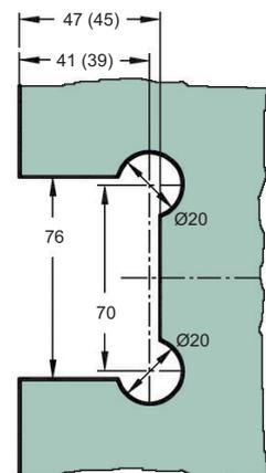
**Art.-Nr. 47 191** Duschtürpendelband **Bilbao Premium HD** mit automatischer Rückholzone von  $\pm 15^\circ$ , Wand-Glas  $90^\circ$ , Öffnungswinkel beidseitig  $90^\circ$ , Nulllage stufenlos einstellbar, für 8 - 12 mm Glasdicke
