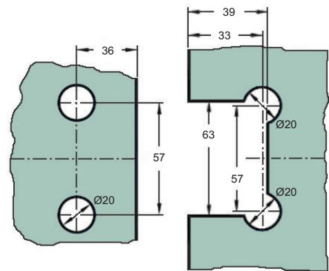
**Glasbearbeitung mit Dichtung Art.-Nr. 46 834 6 76:**
