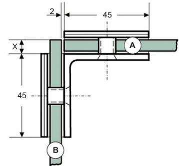
**Art.-Nr. 47 420** Duschtürpendelband **Juna selbstschließend, Wand-Glas 90°**, Öffnungswinkel beidseitig 90°, Nulllage stufenlos einstellbar, für **6 - 10 mm Glasdicke**, Wandbefestigung und Schrauben am Band verdeckt
