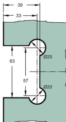
**Glasbearbeitung mit Dichtung Art.-Nr. 46 834 6 76:**
