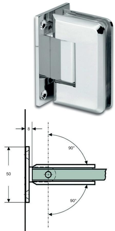
Art.-Nr. 47 447 Duschtürpendelband **Barcelona Select**, mit automatischer Rückholzone von  $\sim \pm 15^\circ$ , Glas-Glas  $90^\circ$ , Öffnungswinkel beidseitig  $90^\circ$ , Nulllage stufenlos einstellbar, für 8 - 12 mm Glasdicke
