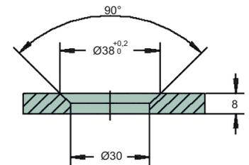
**Art.-Nr. 47 503** Duschtürpendelband **Plan artist** mit **Hebe-Senk-Funktion** (Hubhöhe 5 mm), **Glas-Glas 90°**, **DIN links**, für **8 mm Glasdicke**, Einrastfunktion bei einer Öffnung von ca. 95°, innen flächenbündig, mit einstellbarer Nulllage und inkl. verdeckter Verschraubungen
