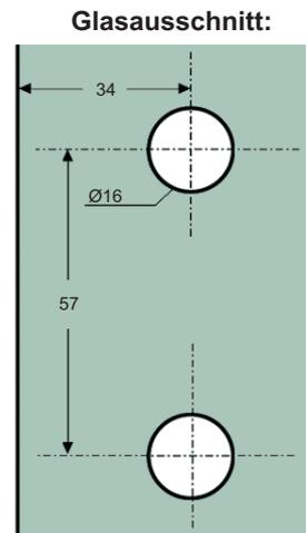
**Art.-Nr. 47 190** Duschtürpendelband **Bilbao Premium HD** mit automatischer Rückholzone von  $\pm 15^\circ$ , Wand-Glas  $90^\circ$ , Öffnungswinkel beidseitig  $90^\circ$ , Nulllage stufenlos einstellbar, für 8 - 12 mm Glasdicke, inkl. verdeckter Wandbefestigung
