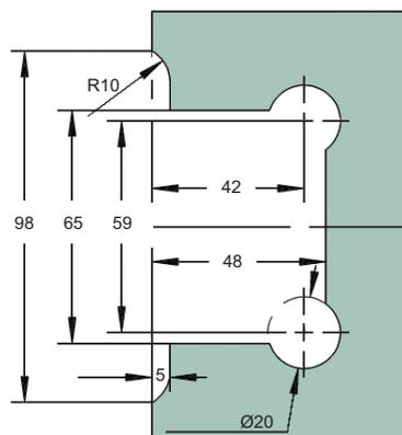
**Art.-Nr. 47 141** Duschtürpendelband **Bilbao** mit automatischer Rückholzone von  $\sim \pm 15^\circ$ , Wand-Glas  $90^\circ$ , Öffnungswinkel beidseitig  $90^\circ$ , für 8 - 12 mm Glasdicke
