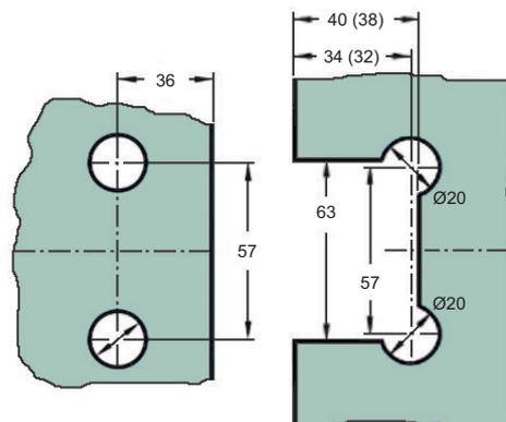
**Art.-Nr. 47 181** Duschtürpendelband **Bilbao Premium** mit automatischer Rückholzone von  $\sim \pm 15^\circ$ , **Glas-Glas 180^\circ**, Öffnungswinkel beidseitig  $90^\circ$ , Nulllage stufenlos einstellbar, für **8 - 12 mm Glasdicke**, inkl. verdeckten Verschraubungen
