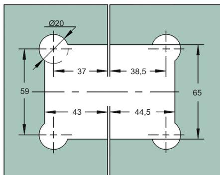
**Art.-Nr. 47 440** Duschtürpendelband **Barcelona Select**, mit automatischer Rückholzone von  $\sim \pm 15^\circ$ , Wand-Glas  $90^\circ$ , Öffnungswinkel beidseitig  $90^\circ$ , Nulllage stufenlos einstellbar, für 8 - 12 mm Glasdicke
