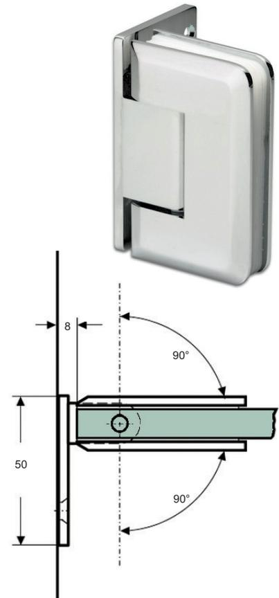
**Art.-Nr. 47 441** Duschtürpendelband **Barcelona Select**, mit automatischer Rückholzone von  $\sim \pm 15^\circ$ , Wand-Glas  $90^\circ$ , Öffnungswinkel beidseitig  $90^\circ$ , Nulllage stufenlos einstellbar, für 8 - 12 mm Glasdicke
