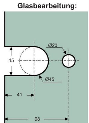
**Art.-Nr. 47 401** Duschtürband **Granada mit Rückholfunktion** (automatisch ~ ±15 Grad), **Glas-Wand 90°**, beidseitige Wandmontage, Öffnungswinkel beidseitig 90°, Nulllage stufenlos einstellbar, für **8 - 10 mm Glasdicke**
