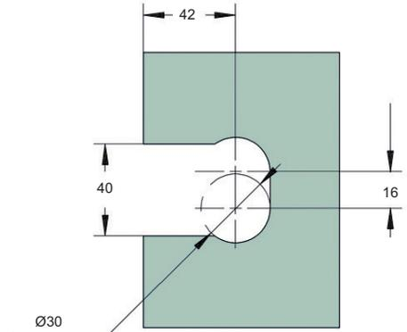
**Art.-Nr. 47 421** Duschtürpendelband **Juna selbstschließend, Glas-Glas 90°**, Öffnungswinkel beidseitig 90°, Nulllage stufenlos einstellbar, für **6 - 10 mm Glasdicke**, Schrauben am Band verdeckt
