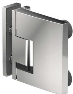
Duschtürpendelband **Pavone** mit Hebe-Senk-Funktion, **Glas-Glas 90°**, für **8 - 10 mm Glasdicke**, Glasbefestigung flächenbündig, mit verstellbarer Nulllagenstellung, Punkthalter unabhängig voneinander  $\pm 2$  mm in jede Richtung verstellbar, **links montiert, beidseitig öffnend**
