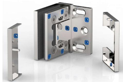
**Mit montagefreundlicher Abdeckung:** Zum Fixieren der Abdeckkappen werden die Zapfen der Abdeckkappe in die vormontierten EPDM-Aufnahmen der Gegenplatte gedrückt. Die Kappen haben im aufgesteckten Zustand einen sicheren Halt. Bei Bedarf können sie jederzeit wieder abgenommen und wieder aufgesteckt werden.
