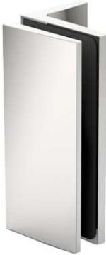
Winkelverbinder **Farfalla**, **Pillango** und **Papillon**, Glas-Wand 90°, für 6 - 10 mm Glasdicke, Wandbefestigung mit Langlochverstellung und verdeckte Verschraubung mit Abdeckkappe
