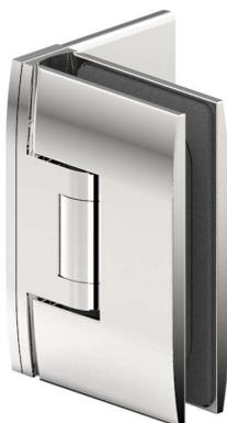
Duschpendeltürband **Pontere**, Glas-Wand 90°, beidseitig 90° öffnend, für 8 / 10\* mm Glasdicke, mit verstellbarer Nulllagenstellung und einseitige Befestigungsglasche mit Langlochverstellung
