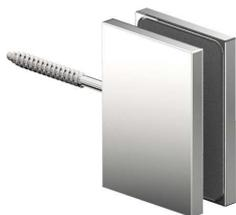
Winkelverbinder für **Fardello, Flamea, Flamea pro mini, Flinter, Fluture** und **Nivello**, starr, **Glas-Wand 90°**, für **8 - 10 mm Glasdicke**, unsichtbare Befestigungsglasche mit Langlochverstellung und Befestigungsschraube
