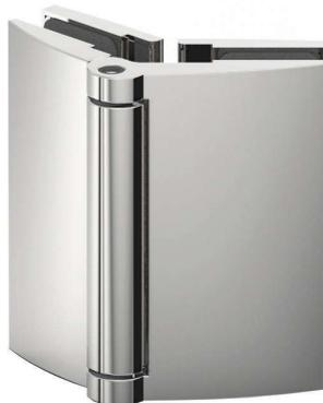
Duschtürband **Farfalla, Glas-Glas 135°, 200° nach außen öffnend**, für 6 - 10 mm Glasdicke (durchgehende Dichtung) und verdeckte Verschraubung mit Abdeckkappe
