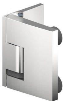
Duschtürpendelband **Pavone** mit Hebe-Senk-Funktion, **Glas-Wand 90°**, für **8 - 10 mm Glasdicke**, Glasbefestigung flächenbündig, verstellbare Nulllagenstellung, einseitige Befestigungslasche innen mit Langlochverstellung und Abdeckplatte, Punkthalter unabhängig voneinander  $\pm 2$  mm in jede Richtung verstellbar, **links montiert, beidseitig öffnend**
