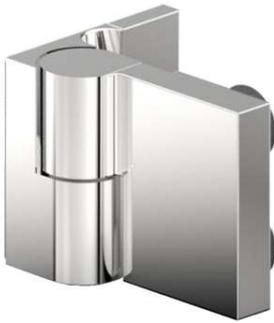
Duschtürband **Nivello+** mit Hebe-Senk-Funktion, **Glas-Wand 90°**, für **8 - 10 mm Glasdicke**, Glasbefestigung flächenbündig, mit verstellbarer Nulllagenstellung, einseitige Befestigungslasche mit Langlochverstellung und Abdeckplatte, Punkthalter unabhängig voneinander  $\pm 2$  mm in jede Richtung verstellbar
