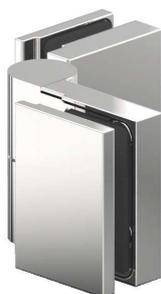
Duschtürband **Nivello** mit Hebe-Senk-Funktion, **Glas-Glas 90°**, für **6 - 10 mm Glasdicke**, Glasbefestigung mit Gegenplatte, verstellbarer Nulllagenstellung und verdeckte Verschraubung inkl. Abdeckkappen
