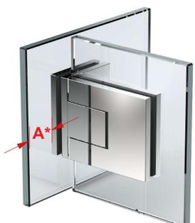
**Beim Beschlag Glas-Glas 90° sind nur Glasbohrungen im Seitenteil nötig, dadurch ist ein Einrücken des Glastürflügels nach innen möglich und der Überstand (A\*) kann selbst bestimmt werden!**
