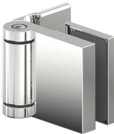
Duschtürband **Flinter**, Glas-Wand 90°, einseitig 90° nach außen öffnend, für 6 - 10 mm Glasdicke, einseitige Befestigungslasche inkl. Langlochverstellung und verdeckte Verschraubungen mit Abdeckkappen, Einrastfunktion bei 0°
