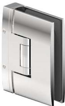
Duschpendeltürband **Pontere**, Glas-Wand 90°, beidseitig 90° öffnend, für 8 / 10\* mm Glasdicke, mit verstellbarer Nulllagenstellung, 7 mm höhenverstellbar
