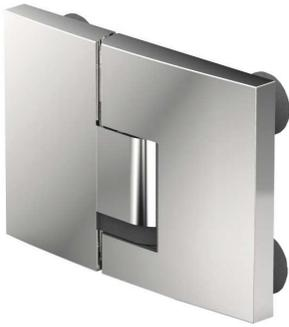
Duschtürpendelband **Pavone** mit Hebe-Senk-Funktion, **Glas-Glas 180°**, für **8 - 10 mm Glasdicke**, Glasbefestigung flächenbündig, verstellbare Nulllagenstellung, Punkthalter unabhängig voneinander  $\pm 2$  mm in jede Richtung verstellbar, **links montiert, beidseitig öffnend**
