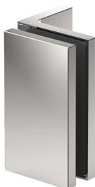
Winkerverbinder **Pontere+**, starr, **Glas-Wand 90°**, für **6 - 10 mm Glasdicke**, Wandbefestigung mit Langlochverstellung und verdeckte Verschraubung mit Abdeckplatte
