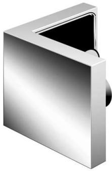
Winkerverbinder **Nivello+**, **Glas-Glas 90°**, für **8 - 10 mm Glasdicke**, Glasbefestigung flächenbündig, inkl. Abdeckplatte, Punkthalter unabhängig voneinander  $\pm 2$  mm in jede Richtung verstellbar
