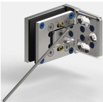
Wenn der Türflügel ausgerichtet ist und alle Dichtprofile aufgesteckt wurden, kann die Nulllage eingestellt werden. Dabei sind die Schrauben beider Nulllagen wechselweise auf das angegebene Drehmoment anzuziehen und nach ca. 15 Minuten nachzuziehen.
