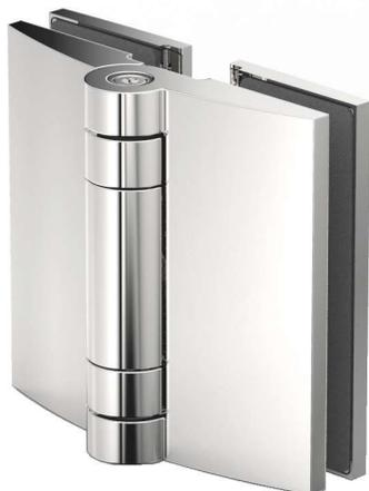
Schwerlast-Duschtürband Tura, Glas-Glas 180°, 180° einseitig nach außen oder innen öffnend / Glas-Glas 90°, 90° einseitig nach innen öffnend, für 8 - 12 mm Glasdicke, mit verstellbarer Nulllagenstellung und verdeckter Verschraubung, Dichtprofil im Bandbereich durchlaufend
