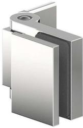
Duschtürband **Flinter**, Glas-Wand 90°, einseitig 90° nach innen öffnend, für 6 - 10 mm Glasdicke, einseitige Befestigungslasche inkl. Langlochverstellung und verdeckte Verschraubungen mit Abdeckkappen, Einrastfunktion bei 0°
