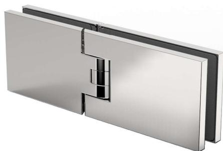
Duschpendeltürband **Fardello**, Glas-Glas 180°, beidseitig 90° öffnend, für **6\* / 8 / 10\* mm Glasdicke**, mit Nulllage (stufenlos und beliebig oft einstellbar), ab **ca. 15° - 20° selbstschließend** und verdeckte Verschraubung mit Abdeckplatten
