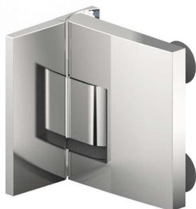
Duschtürpendelband **Pavone** mit Hebe-Senk-Funktion, **Glas-Wand 90°**, für **8 - 10 mm Glasdicke**, Glasbefestigung flächenbündig, verstellbare Nulllagenstellung, einseitige Befestigungsglasche außen mit Langlochverstellung und Abdeckplatte, Punkthalter unabhängig voneinander  $\pm 2$  mm in jede Richtung verstellbar, **links montiert, beidseitig öffnend**
