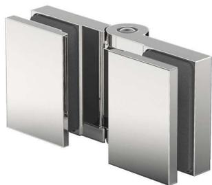
Duschtürband **Flinter**, Glas-Glas 180°, einseitig 180° nach innen öffnend, für 6 - 10 mm Glasdicke, verdeckte Verschraubungen mit Abdeckkappen, Einrastfunktion bei 0°
