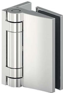
Schwerlast-Duschtürband **Tura**, **Wand-Glas 90°**, mindestens **90° einseitig nach außen öffnend**, für **8 - 12 mm Glasdicke**, mit verstellbarer Nulllagenstellung und einseitige Befestigungsglasche mit Langlochverstellung und Abdeckplatte, Dichtprofil im Bandbereich ausgeklinkt
