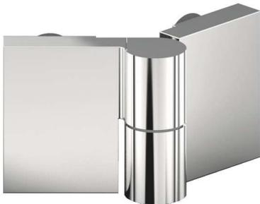
Duschtürband **Nivello+** mit Hebe-Senk-Funktion, **Glas-Glas 135°**, für **8 - 10 mm Glasdicke**, Glasbefestigung flächenbündig, mit verstellbarer Nulllagenstellung, verdeckte Verschraubung mit Abdeckplatte, Punkthalter unabhängig voneinander  $\pm 2$  mm in jede Richtung verstellbar
