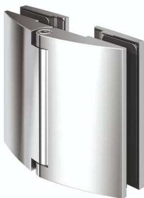
Duschtürband **Papillon**, **Glas-Glas 180°**, **90° nach außen öffnend**, für **6 - 10 mm Glasdicke** (durchgehende Dichtung) und verdeckte Verschraubung mit Abdeckkappen
