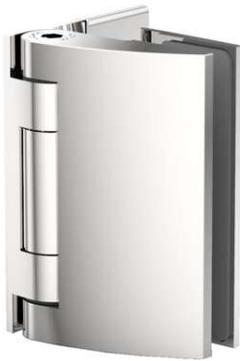
Duschtürband **Pillango**, **Glas-Wand 90°, 90° nach außen öffnend**, für **6 - 10 mm Glasdicke**, Wandbefestigung mit Langlochverstellung und Abdeckplatte, inkl. verstellbarer Nulllagenstellung
