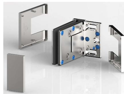
**Mit montagefreundlicher Abdeckung:** Zum Fixieren der Abdeckkappen werden die Zapfen der Abdeckkappe in die vormontierten EPDM-Aufnahmen der Gegenplatte gedrückt. Die Kappen haben im aufgesteckten Zustand einen sicheren Halt. Bei Bedarf können sie jederzeit wieder abgenommen und wieder aufgesteckt werden.
