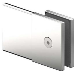
Längsverbinder für **Fardello, Flamea, Flamea pro mini, Flinter, Fluture** und **Nivello**, starr, **Glas-Wand 180°**, für **6 - 10 mm Glasdicke**, Befestigungsglasche mit Langlochverstellung und Abdeckplatte
