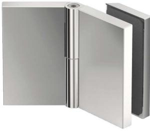
Winkelverbinder **Flamea+**, **Glas-Wand** stufenlos von **100° - 135°** verstellbar, für **6 - 10 mm Glasdicke**, Wandbefestigung mit Langlochverstellung und verdeckte Verschraubung mit Abdeckplatten
