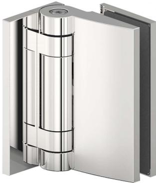
Schwerlast-Duschtürband **Tura**, **Wand-Glas 90°, 90° einseitig nach außen oder innen öffnend**, für **8 - 12 mm Glasdicke**, mit verstellbarer Nulllagenstellung und einseitige Befestigungsglasche mit Langlochverstellung und verdeckter Verschraubung, Dichtprofil im Bandbereich durchlaufend
