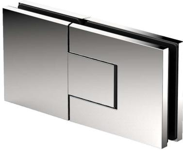
Duschpendeltürband **Pontere+**, **Glas-Glas 180°**, **beidseitig 115° öffnend**, für **6\* / 8 / 10\* mm Glasdicke**, stufenlose Nulllagenstellung, auf den letzten Zentimetern selbstschließend, inkl. Abdeckkappen, Dichtprofil beschlagseitig im Bandbereich unterbrochen
