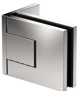
Duschpendeltürband **Pontere+**, **Glas-Wand 90°**, **beidseitig 115° öffnend**, für **6\* / 8 / 10\* mm Glasdicke**, stufenlose Nulllagenstellung, auf den letzten Zentimetern selbstschließend und einseitige Befestigungsglasche mit Langlochverstellung inkl. Abdeckkappe, Dichtprofil beschlagseitig im Bandbereich unterbrochen
