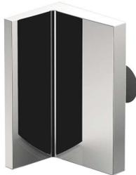
Winkerverbinder **Pavone, Wand-Glas 90°**, für 8 - 10 mm **Glasdicke**, Glasbefestigung flächenbündig, Befestigungsglasche außen mit Langlochverstellung und Abdeckplatte, Punkthalter unabhängig voneinander  $\pm 2$  mm in jede Richtung verstellbar
