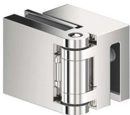
Duschtürband-Set **Fluture**, überlappend, **Glas-Glas 180°**, **180° nach außen öffnend**, für **6 und 8 mm Glasdicke**
