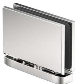
Duschtürdrehband **Modesta**, Glas-Boden / Glas-Decke 360°, beidseitig öffnend, für 8 - 12 mm Glasdicke, schließt ab 25° automatisch, Messing glanzverchromt
