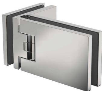
Duschpendeltürband **Fardello**, Glas-Glas 90°, beidseitig 90° öffnend, für 6\* / 8 / 10\* mm Glasdicke, mit Nulllage (stufenlos und beliebig oft einstellbar), ab ca. 15° - 20° selbstschließend und verdeckte Verschraubung mit Abdeckplatten
