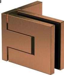
Duschpendeltürband **Flamea pro mini**, **Glas-Wand 90°**, **beidseitig 97° öffnend**, für **6\* / 8 / 10\* mm Glasdicke**, stufenlos verstellbare Nulllageneinstellung, auf den letzten Zentimetern **selbstschließend**, Dichtprofil beschlagseitig im Bandbereich unterbrochen, einseitige Befestigungslasche mit Langlochverstellung und verdeckte Verschraubung mit Abdeckplatten
