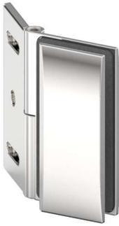
Winkerverbinder **Pontere**, Glas-Wand stufenlos von **90° - 140°** verstellbar, für **8 - 10 mm Glasdicke**, Befestigungsglasche mit Langlochverstellung
