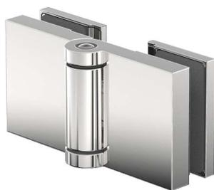
Duschtürband **Flinter**, Glas-Glas 180°, einseitig 180° nach außen öffnend, für 6 - 10 mm Glasdicke, verdeckte Verschraubungen mit Abdeckkappen, Einrastfunktion bei 0°
