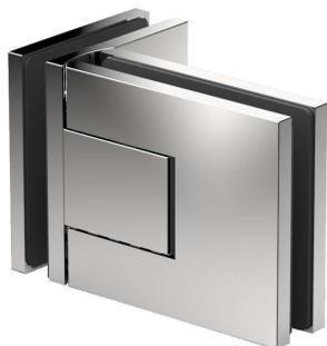
Duschpendeltürband **Pontere+**, **Glas-Glas 90°**, **beidseitig 115° öffnend**, für **6\* / 8 / 10\* mm Glasdicke**, stufenlose Nulllagenstellung, auf den letzten Zentimetern selbstschließend, inkl. Abdeckkappen, Dichtprofil beschlagseitig im Bandbereich unterbrochen
