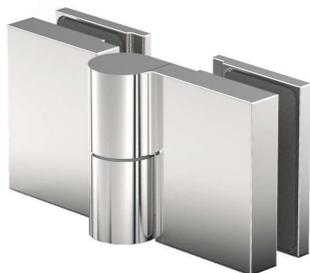
Duschtürband **Nivello** mit Hebe-Senk-Funktion, **Glas-Glas 180°**, für **6 - 10 mm Glasdicke**, Glasbefestigung mit Gegenplatte, verstellbarer Nulllagenstellung und verdeckte Verschraubung inkl. Abdeckkappen, links oder rechts verwendbar
