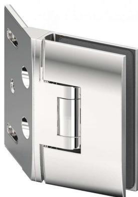
Duschpendeltürband **Pontere**, **Glas-Wand 135°**, je nach verwendeter Dichtung **beidseitig 90° öffnend**, für **8 / 10\* mm Glasdicke**, mit verstellbarer Nulllagenstellung und Befestigungsglasche mit Langlochverstellung
