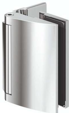
Duschtürband **Papillon**, **Glas-Wand 90°**, **90° nach außen öffnend**, für **6 - 10 mm Glasdicke** (durchgehende Dichtung), Wandbefestigung mit Langlochverstellung und verdeckte Verschraubung mit Abdeckkappen
