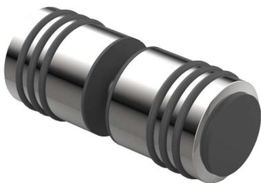
Duschtürknopf für 6 - 13,52 mm Glasdicke, doppelseitig, mit Gummi-Anschlag, Gewindestift und 2 KU-Unterlegscheiben (die O-Ringe sind zu Reinigungszwecken demontierbar)
