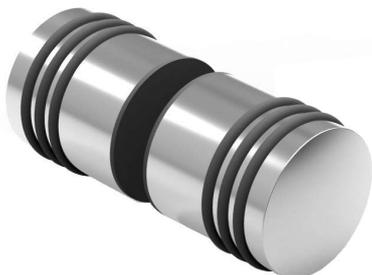
Duschtürknopf für 6 - 13,52 mm Glasdicke, doppelseitig, mit Gewindestift und 2 KU-Unterlegscheiben (die O-Ringe sind zu Reinigungszwecken demontierbar)
