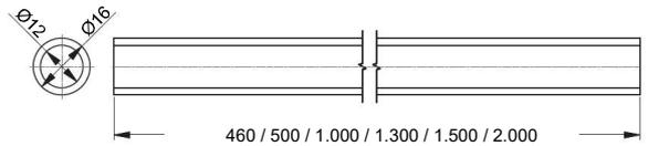
Stabilisierungsstange - Rohr  $\varnothing$  16 mm
