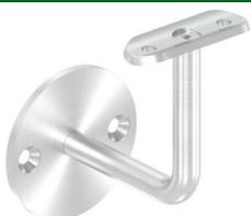
Handlaufhalter mit **verschraubter Anschlussplatte**, Ronde mit **2 Bohrungen Ø 6,5 mm** (gesenkt für M6), Edelstahl V2A 240 Korn geschliffen
