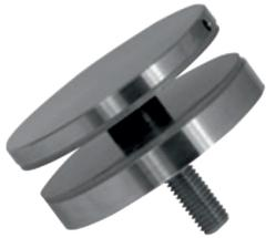
Punkthalter  $\varnothing$  72 mm, für 12 - 21,52 mm Plattendicke, mit 2 KU-Unterlegscheiben, 1 KU-Schlauchstück und Gewindestift M10 x 90 mm, Edelstahl V2A geschliffen
