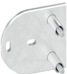
Wandbefestigung **zum Verschrauben**, inkl. 2 x Schraube **M10 x 70 mm** (DIN 7991) und 2 x Distanzhülse - Wandabstand: 53 mm, für **Rohr Ø 42,4 mm**, Edelstahl V2A 240 Korn geschliffen
