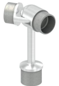
Handlaufstütze mit Kugellring, Stopfen zum Einkleben, für Rohr und Handlauf Ø 42,4 x 2,0 mm, mit höhenverstellbarem Stift, Edelstahl V2A geschliffen
