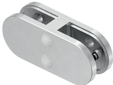
Mittel-Klemm-System **180°** (106 x 45 x 30 mm), mit Gummi-Einlagen, zwei Senkkopfschrauben M6 x 25, zwei Abdeckhauben und zwei Sicherungsstifte, Edelstahl V4A 240 Korn geschliffen
