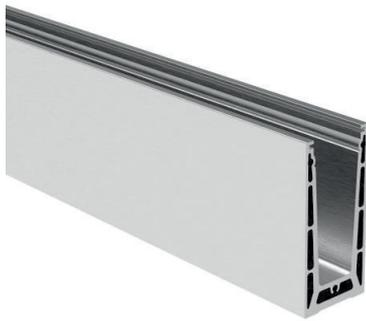
Ganzglasgeländer-Grundprofil für Aufsatzmontage, für 12 - 21,52 mm Glasdicke (verstellbar  $\pm 1,1^\circ$  für 12 - 17,52 mm), Holmlast: 1kN, Aluminium geschliffen silberfarbig eloxiert
