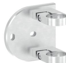
Wandbefestigung für **90° Innenecke**, mit **2 Spannringen**, inkl. 4 x Schraube **M8 x 20 mm** (ISO 10642), Wandabstand: 45 mm, für **Rohr Ø 42,4 mm**, Edelstahl V2A 240 Korn geschliffen
