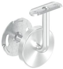
Handlaufhalter mit verschraubter Anschlussplatte (mit 2 Bohrungen  $\text{\O} 6,5 \text{ mm}$ ), Ronde mit 2 Langlöchern  $6,5 \times 21 \text{ mm}$ , inkl. Clipsetze, Edelstahl V2A 240 Korn geschliffen
