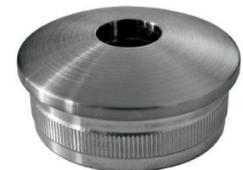
Endkappe, **flach, mit Durchgangsbohrung Ø 12,1 mm**, Vollmaterial, zum **Einschlagen**, Edelstahl V2A 240 Korn geschliffen
