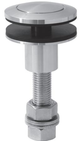
Fassadenpunkthalter  $\varnothing$  80 mm, beweglich, gewölbt, Befestigung von vorne, für 10 - 26 mm Glasdicke, Edelstahl V4A geschichtet
