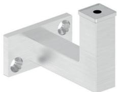
Handlaufhalter mit Durchgangsbohrung, Ronde mit 2 versenkten Bohrungen  $\text{\O} 6,5 \text{ mm}$  (gesenkt für M6), Edelstahl V2A 240 Korn geschliffen
