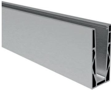
Ganzglasgeländer-Grundprofil für Aufsatzmontage, für 12 - 21,52 mm Glasdicke, Holmlast: 1kN
