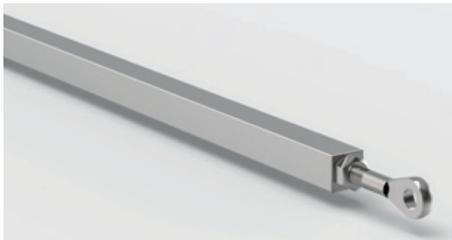
Stangenverbindung **eckig**, mit **2 Ösen**, für **Glasvordach-Set XIX**, (im eingebauten Zustand) stufenlos verstellbar (+/- 25 mm), Edelstahl V2A geschliffen (**Bitte genaue Länge angeben**)
