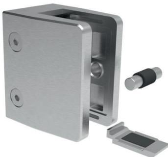
Klemmbefestigung mit Gummi-Einlagen, für **flachen Anschluss**, zwei Senkkopfschrauben, ein Sicherungsstift und Boden zur Absturz-sicherung, rechts und links verwendbar, Edelstahl V4A geschliffen
