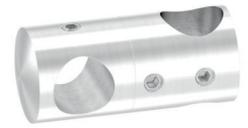
Doppel-Querstabhalter Ø 22 mm mit einer Durchgangsbohrung Ø 12,3 mm und einem Sackloch Ø 12,3 mm, Edelstahl V2A geschliffen
