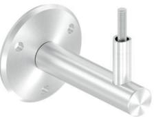
Handlaufhalter mit **Durchgangsbohrung**, Ronde mit **3 Bohrungen Ø 6,5 mm**, inkl. **Schraube M6 x 70 mm** (DIN 966), Edelstahl V2A 240 Korn geschliffen
