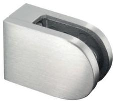
Theken-Klemmbefestigung mit Gummi-Einlagen, zwei Senkkopfschrauben M4 x 10 mm, ein Sicherungsstift (Glasbohrung Ø 6 mm) und eine Zylinderkopfschraube M5 x 18 mm, rechts und links verwendbar
