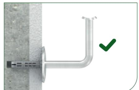
Loch bohren - Dübel setzen - Handlaufhalter mit Ankerstange einführen - Mit einer Vierteldrehung sicher fixieren!
