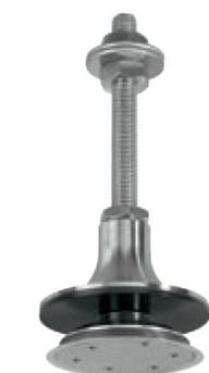
Senkpunkthalter **Ø 60 mm** für Überkopfverglasung, für 13,52, 17,52 und 21,52 mm Glasdicke, Edelstahl V2A geschliffet
