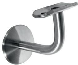
Handlaufhalter mit **verschraubter Anschlussplatte** (mit 2 Bohrungen  $\varnothing$  6,5 mm), Befestigung mittels **Stockschraube M8**
