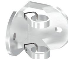
Wandbefestigung für **90° Außenecke**, mit **2 Spannringen**, inkl. 4 x Schraube **M8 x 20 mm** (ISO 10642), Wandabstand: 45 mm, für **Rohr Ø 42,4 mm**, Edelstahl V2A 240 Korn geschliffen
