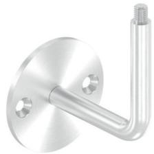
Handlaufhalter mit **Außengewinde M8**, Ronde mit **2 Bohrungen Ø 6,5 mm** (gesenkt für M6), Edelstahl V2A 240 Korn geschliffen
