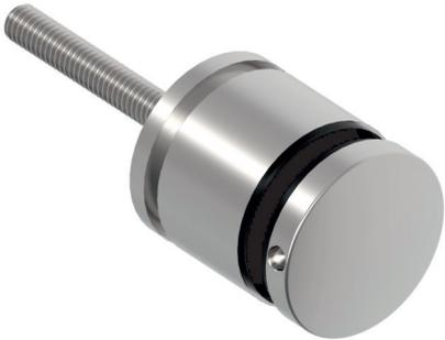
Punkthalter Ø 50 mm für 8 - 17,52 mm Plattendicke, Wandabstand 38 - 58 mm, mit Glasschutz-Set und Gewindestift M10 x 125 mm
