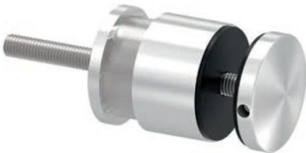
Punkthalter  $\varnothing$  52 mm, für 6 - 25,52 mm Plattendicke, verstellbarer Wandabstand 33 - 55 mm, inkl. schwarzem Glasschutz-Set und Gewindestift M10 x 130 mm, Edelstahl V2A 240 Korn geschliffen
