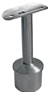
Handlaufstütze mit Anschlussplatte (mit 2 Bohrungen Ø 6,5 mm), Stopfen zum Einkleben / Einschweißen, für Rohr Ø 42,4 x 2,0 mm
