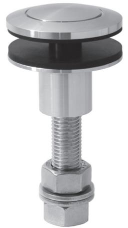
Fassadenpunkthalter  $\varnothing$  60 mm, beweglich, gewölbt, Befestigung von vorne, für 10 - 26 mm Glasdicke, Edelstahl V4A geschichtet
