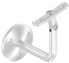
Handlaufhalter mit **Gelenk** und **verschraubter Anschlussplatte** (mit 2 Bohrungen  $\varnothing$  6,5 mm), Ronde mit **3 Bohrungen  $\varnothing$  6,5 mm**, Edelstahl V2A 240 Korn geschliffen
