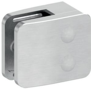
End-Klemmbefestigung mit Gummi-Einlagen, zwei Senkkopfschrauben M6 x 16 mm, zwei Abdeckhauben und eine Zylinderskopfschraube M8 x 20 mm, rechts und links verwendbar
