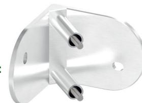
Wandbefestigung für **90° Außenecke**, **zum Verschrauben**, inkl. 2 x Schraube **M8 x 90 mm** (ISO 10642) und 2 x Distanzhülse - Wandabstand: 50 mm, für **Rohr Ø 42,4 mm**, Edelstahl V2A 240 Korn geschliffen
