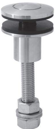
Fassadenpunkthalter  $\varnothing$  45 mm, beweglich, gewölbt, Befestigung von vorne, für 8 - 22 mm Glasdicke, Edelstahl V4A geschichtet
