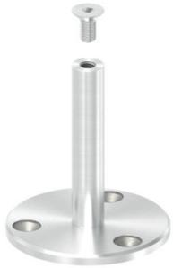
Handlaufstützen zum Aufschauben, mit Innengewinde M6, Ronde mit 3 Bohrungen Ø 5,5 mm, inkl. Senkkopfschraube M6 x 12 mm, Edelstahl V2A 240 Korn geschliffen
