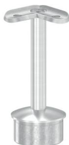
Handlaufstütze mit **verschraubter Anschlussplatte 135°** (mit 2 Bohrungen Ø 6,5 mm), Stopfen **zum Einkleben / Einschweißen**, Edelstahl V2A 240 Korn geschliffen
