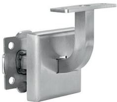
Handlaufhalter mit verschraubter, flacher Anschlussplatte (mit 2 Bohrungen  $\text{\O} 6,5 \text{ mm}$ ), Ronde mit 4 Bohrungen  $\text{\O} 7 \text{ mm}$ , inkl. Clipsetze, Edelstahl V2A geschliffen
