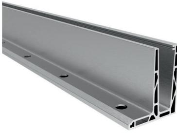
Ganzglasgeländer-Grundprofil für Aufsatzmontage, für 12 - 21,52 mm Glasdicke, Holmlast: 1kN
