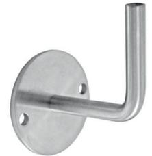
Handlaufhalter mit **Innengewinde M6**, Ronde mit **2 Bohrungen  $\text{\O} 6,5 \text{ mm}$**  (gesenkt für M6), Edelstahl V2A 240 Korn geschliffen
