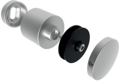
Punkthalter Ø 50 mm für 8 - 17,52 mm Plattendicke, Wandabstand 42 - 50 mm, mit Glasschutz-Set, Wandadapter und Gewindestift M10 x 40 mm
