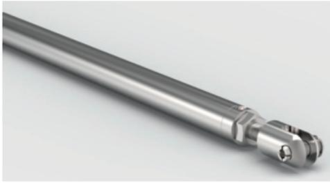
Stangenverbindung **rund**, mit **Öse / Gabel**, (im eingebauten Zustand) stufenlos verstellbar (+/- 25 mm), Edelstahl V2A geschliffen (**Bitte genaue Länge angeben**)
