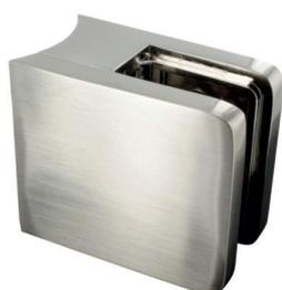
Klemmbefestigung mit Gummi-Einlagen, zwei Sicherungsschrauben M6 x 15 mm, zwei Abdeckhauben und eine Inbusschraube M8 x 20 mm, rechts und links verwendbar
