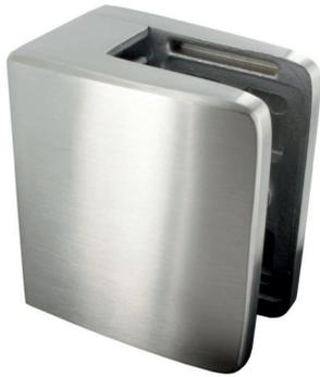
Klemmbefestigung mit Gummi-Einlagen, zwei Senkkopfschrauben M6 x 16 mm, zwei Abdeckhauben und eine Zylinderskopfschraube M8 x 20 mm, rechts und links verwendbar
