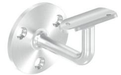
Handlaufhalter mit Anschlussplatte (mit 2 Bohrungen  $\varnothing 4,2$  mm - zum Vernieten), Ronde mit 3 versenkten Bohrungen  $\varnothing 6,5$  mm (gesenkt für M6)
