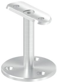
Handlaufstützen mit verschraubter Anschlussplatte (mit 2 Bohrungen Ø 6,5 mm), für Rohr Ø 42,4 mm, Ronde mit 3 versenkten Bohrungen Ø 5,5 mm, Edelstahl V2A 240 Korn geschliffen
