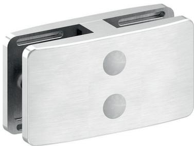
Mittel-Klemm-System **180°** (92 x 52 x 30 mm) mit Gummi-Einlagen, zwei Senkkopfschrauben M6 x 16 mm, zwei Abdeckhauben und 2 Sicherungsstiften, Edelstahl V4A 240 Korn geschliffen
