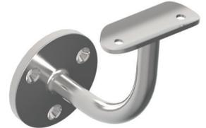
Handlaufhalter mit Anschlussplatte (mit 2 versetzten Bohrungen  $\varnothing 4,2$  mm - zum Vernieten), Ronde mit 3 versenkten Bohrungen  $\varnothing 8,5$  mm (gesenkt für M6), Edelstahl V2A 240 Korn geschliffen
