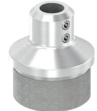
Endkappe, **gewölbt, mit Durchgangsbohrung Ø 12,3 mm**, Vollmaterial, zum **Einschlagen**, für **Rohr Ø 42,4 x 2,0 mm**, Edelstahl V2A geschliffen
