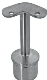
Handlaufstütze mit Anschlussplatte 90° (mit 2 Bohrungen Ø 6 mm), Stopfen zum Einkleben / Einschweißen, für Rohr Ø 42,4 x 2,0 mm
