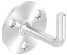
Handlaufhalter zum Anschweißen, Ronde mit 3 versenkten Bohrungen Ø 8,5 mm (gesenkt für M6), Edelstahl V2A 240 Korn geschliffen
