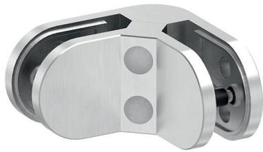
Winkel-Klemm-System **90° Ecke** (82 x 45 x 30 mm), mit Gummi-Einlagen, zwei Senkkopfschrauben M6 x 25 mm, zwei Abdeckhauben und zwei Sicherungsstiften
