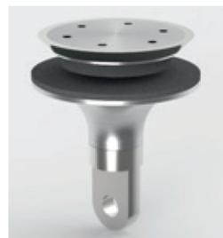
Senkpunkthalter **Ø 60 mm** für Überkopfverglasung, mit Öse, für **Glasvordach-Set XIV** und für 13,52, 17,52 und 21,52 mm Glasdicke, Edelstahl V2A geschliffet
