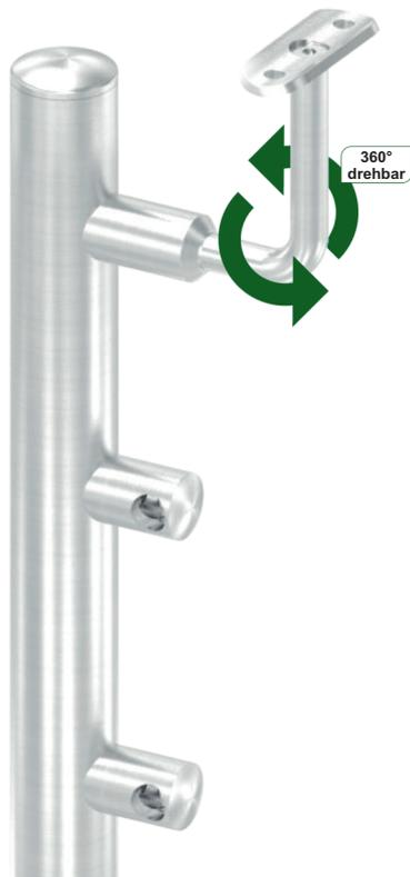
Querstabhalter, zum Stoßen von vorne, inkl. Befestigungsschraube M6 x 16 mm (DIN 912)
