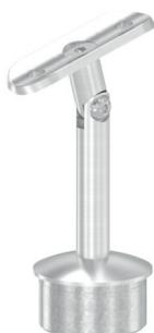
Handlaufstütze mit **Gelenk** und **verschraubter Anschlussplatte** (mit 2 Bohrungen Ø 6,5 mm), Stopfen **zum Einkleben / Einschweißen**, Edelstahl V2A 240 Korn geschliffen
