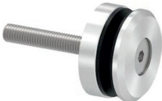
Punkthalter Ø 50 mm, für 6 - 21,52 mm Plattendicke, inkl. schwarzem Glasschutz-Set und Senkkopfschraube M10 x 80 mm
