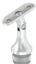
Handlaufstütze mit Gelenk und Anschlussplatte (mit 2 Bohrungen  $\varnothing$  6,5 mm), Stopfen zum Einschlagen, Edelstahl V2A 240 Korn geschliffen
