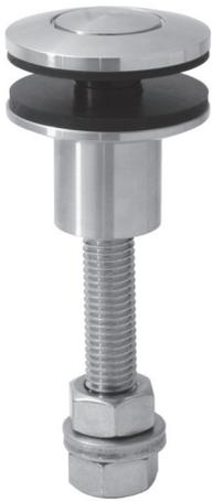
Fassadenpunkthalter  $\varnothing$  45 mm, starr, gewölbt, Befestigung von vorne, für 8 - 22 mm Glasdicke, Edelstahl V4A geschichtet
