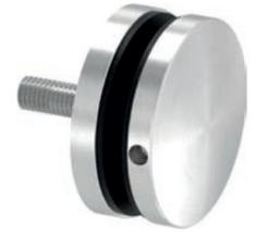
Punkthalter  $\varnothing$  60 mm für 8 - 17,52 mm Plattendicke, mit Glasschutz-Set und Gewindesttift M10 x 100 mm, Edelstahl V2A geschliffen
