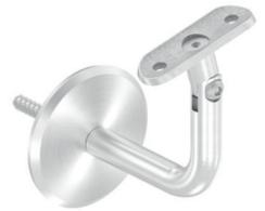
Handlaufhalter mit **verschraubter Anschlussplatte** (mit 2 Bohrungen  $\text{\O} 6,5 \text{ mm}$ ), Ronde mit **2 versenkten Bohrungen  $\text{\O} 6,5 \text{ mm}$**  (gesenkt für M6), Edelstahl V2A 240 Korn geschliffen
