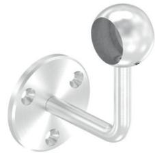
Handlaufhalter mit **verschraubtem Kugelring**, Ronde mit **3 versenkten Bohrungen  $\varnothing$  6,5 mm** (gesenkt für M6), Edelstahl V2A 240 Korn geschliffen
