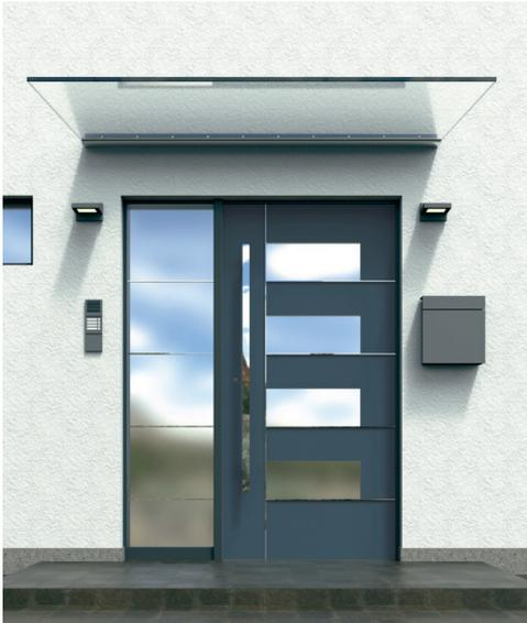
Freitragendes Vordachsystem, Ausladung max. 1.100 mm, Aluminium silberfarbig eloxiert E6/EV1 - **ohne Glas** (für VSG aus TVG mit SentryGlas®-Zwischenlage)
