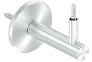
Handlaufhalter mit verschraubter, flacher Anschlussplatte (mit 2 Bohrungen Ø 6,5 mm), hohl für LED Handlauf, Ronde mit 3 versenkten Bohrungen Ø 5,5 mm, Edelstahl V2A geschliffen
