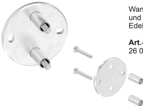
Wandbefestigung **zum Verschrauben**, inkl. 2 x Schraube **M10 x 70 mm** (DIN 7991) und 2 x Distanzhülse - Wandabstand: 53 mm, für **Rohr Ø 42,4 mm**, Edelstahl V2A 240 Korn geschliffen
