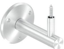
Handlaufhalter mit **Durchgangsbohrung**, Ronde mit **3 Bohrungen Ø 6,5 mm**, inkl. **Schraube 6 x 70 mm** (Holz), Edelstahl V2A 240 Korn geschliffen
