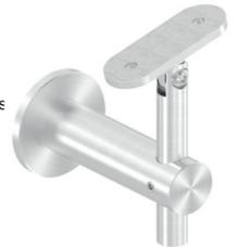
Handlaufhalter mit **Gelenk**, **verschraubter, flacher Anschlussplatte** (mit 2 Bohrungen  $\varnothing$  6,5 mm) und **verstellbarer Höhe** und **Innengewinde M8**, Edelstahl V2A 240 Korn geschliffen
