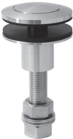
Fassadenpunkthalter  $\varnothing$  60 mm, starr, gewölbt, Befestigung von vorne, für 10 - 26 mm Glasdicke, Edelstahl V4A geschichtet
