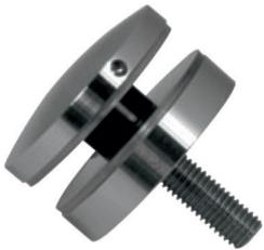
Punkthalter, gewölbt,  $\varnothing$  52 mm, für 12 - 21,52 mm Plattendicke, mit 2 KU-Unterlegscheiben, 1 KU-Schlauchstück und Gewindestift M10 x 90 mm, Edelstahl V2A geschliffet
