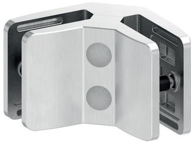
Winkel-Klemm-System **90° Ecke** (72 x 52 x 30 mm), mit Gummi-Einlagen, zwei Senkkopfschrauben M6 x 25 mm, zwei Abdeckhauben und 2 Sicherungsstiften
