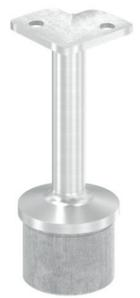
Handlaufstütze mit Anschlussplatte 90° (mit 2 Bohrungen Ø 6 mm), Stopfen zum Einkleben / Einschweißen, für Rohr Ø 42,4 x 2,0 mm, Edelstahl V2A geschliffen
