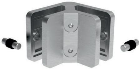
Mittel-Klemm-System **180°** mit Gummi-Einlagen, zwei Senkkopfschrauben und zwei Sicherungsstiften, Edelstahl V4A geschliffen
