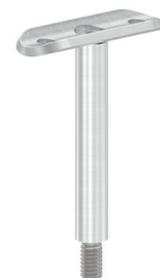
Gelenkstift Ø 14 mm mit **Anschlussplatte** (mit 2 Bohrungen Ø 5,5 mm) und **1 x Außengewinde M10**
