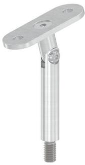
Gelenkstift mit **verschraubter Anschlussplatte** (mit 2 Bohrungen  $\varnothing 6,5$  mm) und **1 x Außengewinde M8**, Edelstahl V2A 240 Korn geschliffen
