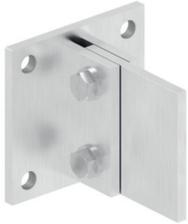
Wandbefestigung, in alle Richtungen verstellbar, für beliebige Rohre, zum Anschweißen, Wandabstand 113 - 120 mm (Bei Bedarf kann die Lasche auch selbst gekürzt werden), Edelstahl V2A 240 Korn geschliffen
