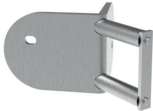
Wandbefestigung für **90° Außenecke, zum Verschrauben**, inkl. 2 x Schraube, 2 x Distanzhülse - Wandabstand: 50 mm und 1 x Verstärkungsplatte, für **Rohr Ø 42,4 mm**, Edelstahl V4A geschliffen
