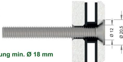
Bohrung min. Ø 18 mm
