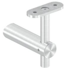
Handlaufhalter mit **verschraubter Anschlussplatte** (mit 2 Bohrungen Ø 5,5 mm) und **verstellbarer Höhe** (Lieferung ohne Befestigungsschraube - kann mit einer M6 x 30 mm oder M8 x 30 mm Senkkopfschraube ISO 10642 befestigt werden), Edelstahl V2A 240 Korn geschliffen
