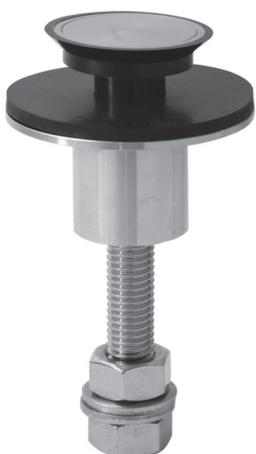
Fassadenpunkthalter  $\varnothing$  60 mm, beweglich, versenkt, Befestigung von vorne, mit Senkbuchse aus POM-Material, für 12 - 26 mm Glasdicke, Edelstahl V4A geschliffet
