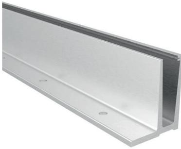
Ganzglasgeländer-Grundprofil für Aufsatzmontage, für 12 - 21,52 mm Glasdicke, Holmlast: 1kN, Aluminium geschliffen silberfarbig eloxiert
