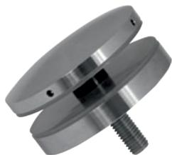
Punkthalter, gewölbt,  $\varnothing$  72 mm, für 12 - 21,52 mm Plattendicke, mit 2 KU-Unterlegscheiben, 1 KU-Schlauchstück und Gewindestift M10 x 90 mm, Edelstahl V2A geschliffen
