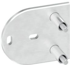
Wandbefestigung **zum Verschrauben**, inkl. 2 x Schraube **M8 x 65 mm** (ISO 10642) und 2 x Distanzhülse - Wandabstand: 50 mm, für **Rohr Ø 42,4 mm**, Edelstahl V2A 240 Korn geschliffen
