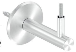
Handlaufhalter mit Durchgangsbohrung, inkl. Stockschraube M8 x 80 mm (Art.-Nr. 86 470 8 00) und Schraube 6 x 70 mm (Holz), Edelstahl V2A 240 Korn geschliffen
