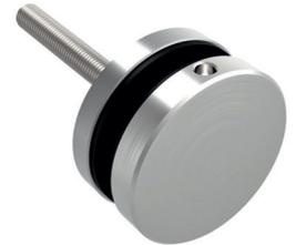
Punkthalter  $\varnothing$  60 mm für 8 - 17,52 mm Plattendicke, für Rohr  $\varnothing$  42,4 mm, mit Glasschutz-Set und Gewindesttift M10 x 100 mm, Edelstahl V2A geschliffen
