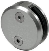
Klemmbefestigung (**Mittel-Klemmbefestigung**) zur Montage vorgesetzter Platten, für **8 - 12,76 mm Plattendicke**, mit Gummi-Einlagen, einer Madenschraube zur Glasdickenregulierung und zwei Senkkopfschrauben M6 x 16 mm
