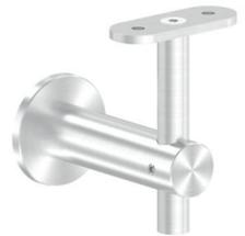
Handlaufhalter mit **Gelenk**, **verschraubter Anschlussplatte** (mit 2 Bohrungen  $\varnothing$  5,5 mm) und **verstellbarer Höhe** und **Innengewinde M8**, Edelstahl V2A 240 Korn geschliffen
