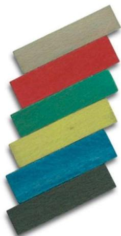
Klotzholz, Länge 80 mm, aus spezialimprägnierten Hartholz (ausreichende Druckfestigkeit), verursachen keine Absplinterungen an der Glaskante (Hergestellt in Übereinstimmung mit den Technischen Richtlinien des Glaserhandwerks Nr. 3 „Klotzung von Verglasungseinheiten“)
